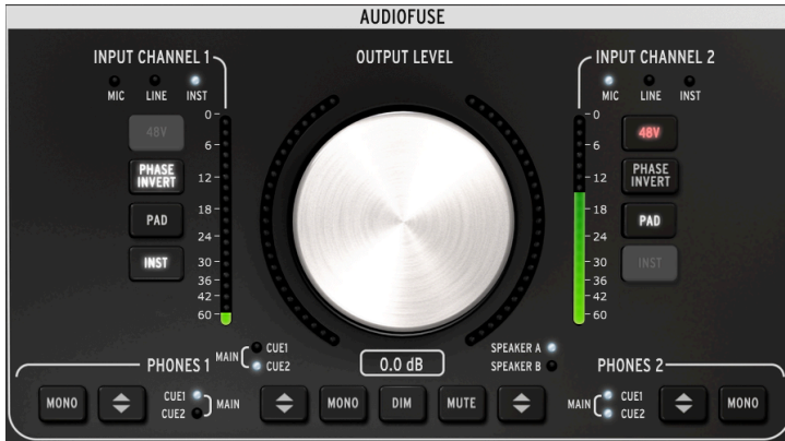
La sección de entradas/salidas principales del Centro de Control
