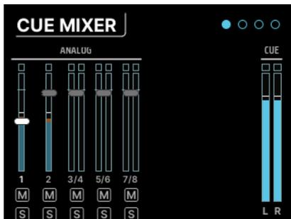
しかしその用途は、必ずしもヘッドフォンでのモニター用とは限りません — キューミキサーをミキサー内の別のミキサーとして活用できます。例えば、大量のモジュールやシンセサイザーで作業をするときに、ステレオのサブミックスを作成し、そのミックスをアナログや ADAT アウトから出力して、さらに加工するといった使い方もできます。
