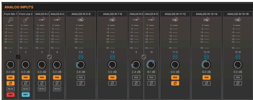
オーバービュー画面の左上には、アナログインプットのメーターとコントロール類が表示されます。これらは AudioFuse 16Rig 本体のミラーリングですが、全インプットを俯瞰できます。各インプットにレベルメーター、隣接したインプットとペアにする **ステレオリンク** ボタン、ゲインノブ、**PAD** や **位相反転** ボタンがあります。
