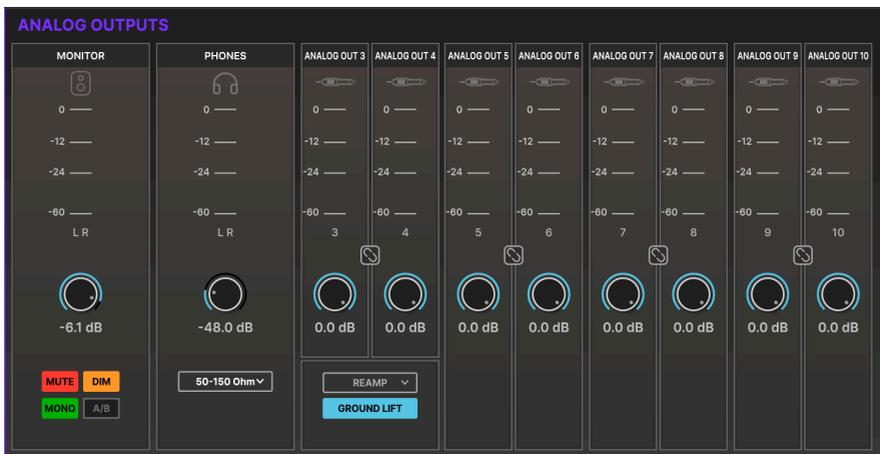
オーバービュー画面の左下には、アナログアウトプットの全チャンネルのレベルメーターとコントロール類が表示されます。各アウトプットにメーター、隣接したモノチャンネルとペアにする **ステレオリンク** ボタン、出力レベルノブがあります。
