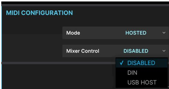
**Mixer Control** メニューでは、メインミキサーをリアパネルの DIN ポートでコントロールするか、USB HOST ポートでコントロールするか、あるいは MIDI でのコントロールをしないかを選択します。メインミキサーを MIDI でコントロールする予定がない場合は、他の MIDI メッセージにメインミキサーが誤って反応してしまわないように、DISABLED に設定しておくことをお勧めします。
