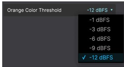
AudioFuse 16Rig のメーターは、レベルが低いときはグリーンで、信号がクリップしているときは赤で表示します。その中間のレベルでは、オレンジ色で表示します。オレンジ色の表示を、クリップに近づいているという警告と捉える人もいれば、そうでないと考えている人もいます。
