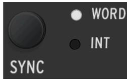
**i** Si no hay ningún cable BNC conectado a la entrada del WORD CLOCK del panel trasero, el botón de SYNC no hace nada: la unidad pasa por defecto a sincronización interna y no se puede cambiar.
