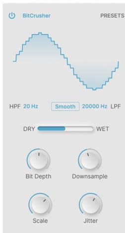
ビットクラッシャーは、デジタル・オーディオ信号を次の2つの方法で劣化させます：1) オーディオ信号のビット解像度を低下させ、2) サンプルレートを低下させます。このエフェクトで初期デジタル時代のデジタル的にザラツとした質感を出すことができます。
