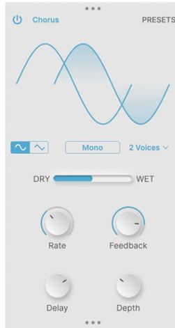
コーラスは定番のモジュレーションエフェクトで、比較的短いディレイを LFO で変調してうねりや音の厚みを作り、複数の音が一斉に鳴っている状態を演出します。
