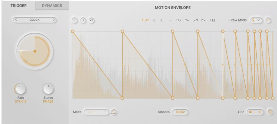
オーディオパス [p.11]の5つのモジュールのそれぞれには、モーションエディターのパラメーターセットがあり、モジュールの動きを独立して設定できます。これにより、単純なコピーではなく、複雑に絡み合ったエフェクトモジュレーションを構築することができます。
