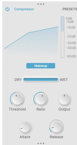
コンプレッサーは、設定したレベル(スレッシュولد)を超える音を小さくして、入力信号のダイナミクスを調整するエフェクトです。コンプレッサーが反応するまでの時間や、ゲインリダクション(スレッシュولدを超えた信号を抑える)動作のさせ方で音色キャラクターが変わります。
