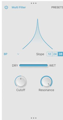
マルチフィルターは、一風変わったバリエーションもあるマルチモードフィルターです。ローパス、ハイパス、バンドパスの各モードでは一般的なフィルターでは見られない急峻な 36dB/oct のスロープが使用でき、2タイプのコムフィルター（フィードフォワードとフィードバック）ではフランジャーのようなトーンになります。
