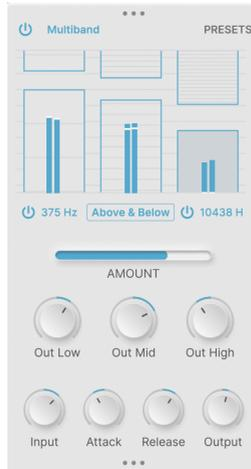
マルチバンドコンプレッサーは、入力信号をいくつかの帯域に分割し、それぞれの帯域でのダイナミクスを調整するエフェクトです。これにより、例えば低音域はそのまま、中音域と高音域のダイナミクスのみを調整することができます。
