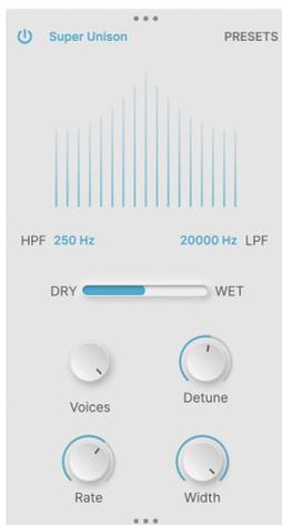
スーパーユニゾンは、1990年代のバーチャルアナログ・シンセサイザーで初めて開発されたものでした。入力信号を遅延させてコピーを作り、リッチでよりパワフルな音にするというものでした。
