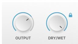
**OUTPUT** と **DRY/WET** ノブは、Efx MOTIONS の全体的な出力レベル (OUTPUT ノブ) と、ドライ/ウェット (入力信号とエフェクト成分) のミックスバランス (DRY/WET ノブ) を調整します。DRY/WET ノブの右上にカギのアイコンが表示されているときは、プリセットを切り替えてもドライ/ウェットのバランスが固定されたままになります。
