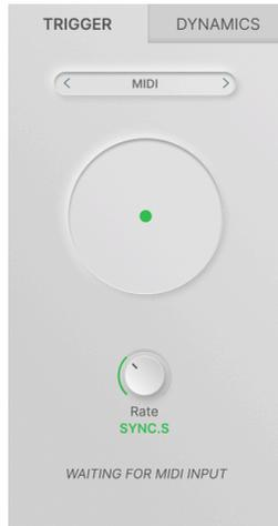
トリガーエンジンの最後は、MIDI ノートでモーションエンベロープをリトリガーする MIDI エンジンです。ノートオン、ノートオフメッセージのほか、スタートとストップコマンドを使用する MIDI エンジンは、モーションモードの4つ (Loop、One-Shot、Envelope、Envelope Loop) のすべてを使用できる唯一のエンジンです。
