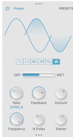
フェイザー (フェイズシフター) は、一連のオールパスフィルターを使用して入力信号の位相を変化させるエフェクトです。フィルターのセッティングを LFO で変調すると、コーラスやフランジャーとはキャラクターが異なるリッチなうねりが生じます。
