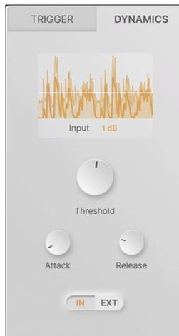
ダイナミクスは、入力信号の音量変化をベースにコントロール信号を作り出す エンベロープフォロワーのモジュールです。これにより、アグレッシブなギター演奏やドラムマシンのループのアクセント部分など、入力信号の音量変化に応じて反応するパッチを作成できます。
