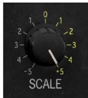
Schließlich bestimmt **Scale** die Gesamtstärke des Effekts der Function. Die Option hat einen Regelbereich von -1.0 bis +1.0. Negative Werte kehren die Form der Function um. Dieser Effekt wird grafisch in der Anzeige dargestellt, sobald Sie Scale ändern.
