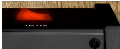
Ja, der große rote **Ein/Aus**-Schalter auf der Rückseite besitzt eine Funktion! Es handelt sich um einen zweiten Bypass-Schalter. Kein Detail darf fehlen...
