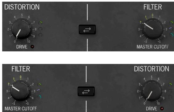
Die Schaltfläche **Swap** vertauscht einfach die Reihenfolge, in der das Signal durch das Plug-In läuft. Sie können die Verzerrung vor dem Filter oder das Filter vor der Verzerrung platzieren. Klicken Sie auf „Swap“, um die Signalverarbeitungsreihenfolge umzukehren.
