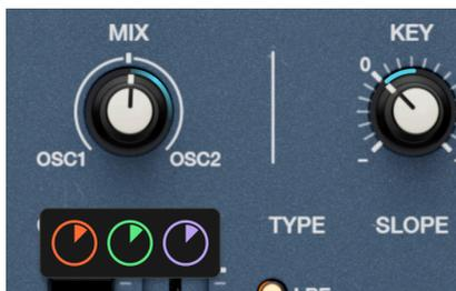
*Envelope-, Functions- und Zufallsquellen sind alle dem Oszillator-Mix zugewiesen*
