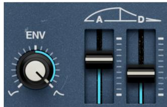
*Attack- und Decay-Zeiten stehen auf einer Sekunde; maximale Hüllkurven-Intensität*
