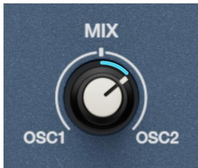
*Das Signal von Oszillator 2 wird durch das ringmodulierte Signal von Oszillator 1 am Mix-Regler ersetzt*
