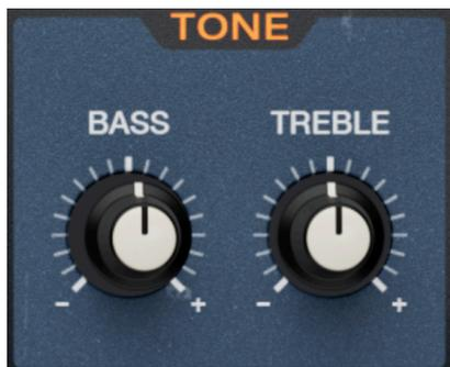
Ces simples contrôles d'amplification/atténuation augmentent ou réduisent les fréquences hautes et basses. En effet, ce sont des égaliseurs en plateau avec des fréquences de 230 Hz pour les graves et de 1 500 Hz pour les aigus.
