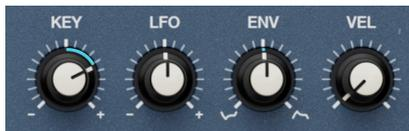
Quatre sources peuvent moduler la fréquence de coupure du filtre et animer ainsi le timbre sonore. Chacune a un bouton permettant d'ajuster la profondeur.
