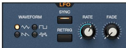
Voici ce que nous appelons le LFO principal de Jup-8000 V. Il s'agit du LFO dont la profondeur affectant diverses sources est réglée par les boutons **LFO** dans les parties Oscillator, Filter et autres. (Un second LFO est lié à la molette de modulation dans la partie [contrôles de performance \[p.37\]](#) du panneau).
