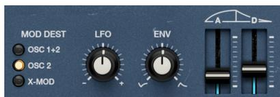
La moitié droite de la partie Oscillator Common contient une enveloppe de modulation. C'est une enveloppe dédiée avec deux phases temporelles : l'Attack et le Decay. Il est possible de l'assigner à la hauteur des Oscillators 1 et 2, à la hauteur de l'Oscillator 2 seul ou de moduler le bouton **X-Mod** [p.27] décrit ci-dessus.
