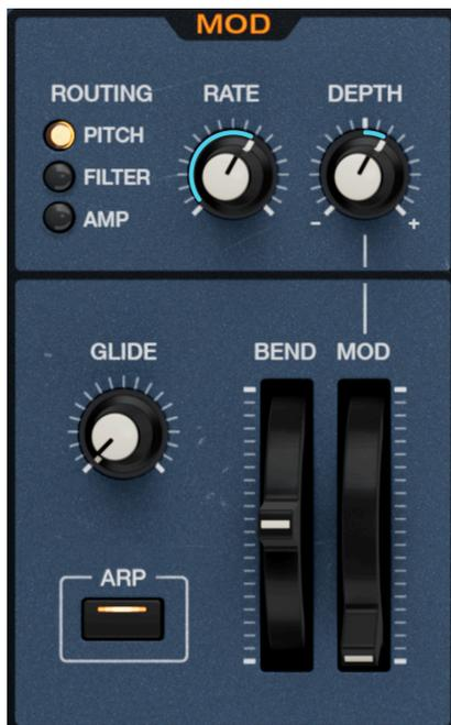
Une partie **MOD**, située à gauche du clavier à l'écran, contient des molettes, un bouton Glide, ainsi qu'un LFO assignable relié à la molette Modulation.
