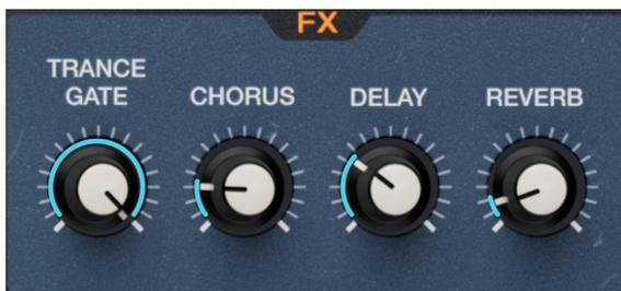
Ces quatre boutons font office de « miroirs » pour les curseurs Dry/Wet d'un maximum de quatre effets sous l'onglet [Effects \[p.67\]](#) de la vue Advanced. Leurs positions de gauche à droite correspondent à l'ordre des effets et les noms des boutons changent pour correspondre au dispositif d'effet dans chaque emplacement. Si un emplacement est vide (sans effet), le bouton correspondant est grisé.
