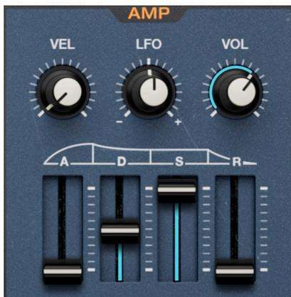
Amplitude (VCA en jargon de synthétiseur analogique) dispose de son enveloppe dédiée, de nouveau avec des contrôles ADSR :
