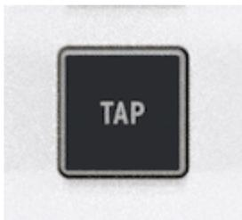
Con Tap Tempo puedes configurar el reloj interno que el KeyLab Essential usará para el arpegiador marcando un ritmo con pulsaciones sucesivas. Si tocas con más personas en un grupo y hay un batería (o una caja de ritmos que no está conectada por MIDI ni sincronizada), esta función te permite sincronizar de oído el KeyLab Essential.
