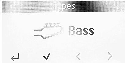
Gira el **codificador principal** (la rueda codificadora que hay debajo de la pantalla) para moverte por los distintos tipos de instrumentos. Pulsa la rueda codificadora para seleccionar ese tipo. Ahora puedes girar la rueda codificadora para moverte por los subtipos únicamente dentro del tipo que has seleccionado.
