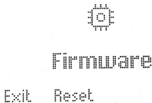
4. Deja de pulsar los botones 1 y 2. Pulsa **Reset** para restablecer los ajustes originales de fábrica del KeyLab Essential, o bien pulsa **Exit** para salir de esta función y regresar al funcionamiento normal.
