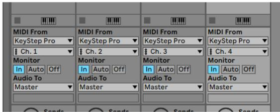
In diesem Setup werden die vier KeyStep Pro-Tracks auf den vier entsprechenden Ableton Live-Tracks abgespielt.
