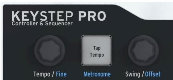
Der Tempo/Fine-Regler stellt das Tempo auf 30-240 Schläge pro Minute (BPM) ein. Wenn Sie diesen Regler drehen, wird der BPM-Wert automatisch auf die nächste ganze Zahl gerundet und auf dem OLED-Display des KeyStep Pro angezeigt. Wenn Sie beim Drehen dieses Reglers den 'Shiff'-Taster gedrückt halten, erhalten Sie eine feinere BPM-Einstellung mit Nachkommastellen.
