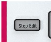
Im Step Edit-Modus können Sie mit den fünf Haupt\_Reglern die Tonhöhe, das Gate, die Velocity, Time 'Shift' und/oder die Zufälligkeit einer oder mehrerer Noten im aktiven Schritt bearbeiten. Es gibt viel zu entdecken und zu lernen, wie dieser simple Taster funktioniert. Weitere Informationen finden Sie in [Kapitel 5 \[p.78\]](#).
