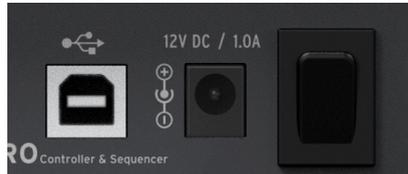
Der USB-Anschluss bietet eine Datenverbindung zu Ihrem Computer oder Tablet, wenn Sie das KeyStep Pro mit einem Hostgerät verwenden möchten. Wenn Sie das nutzen wollen, schließen Sie das KeyStep Pro einfach mit dem mitgelieferten USB-Kabel an Ihr Host-Gerät an und schalten Sie es ein.
