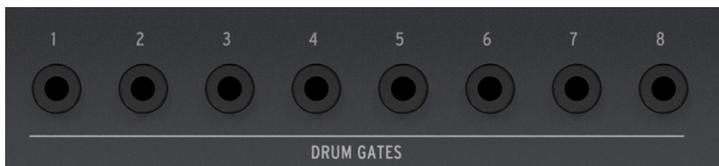
**i** Diese Gate-Signale sind nicht auf das Auslösen von Drum-Sounds beschränkt. Sie können diese Ausgänge an jeden Eingang anschließen, der ein Trigger- oder Gate-Signal akzeptiert, einschließlich eines ADSR-Hüllkurvengenerators oder eines LFO-Resets. Experimentieren Sie damit! Wir sind unsicher, dass Sie einige reizvolle rhythmische Anwendungen finden werden.
