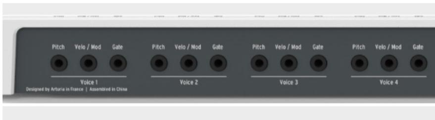
Der Pitch CV-Ausgang wird hauptsächlich zur Steuerung der Tonhöhe eines externen spannungsgesteuerten Oszillators (VCO) verwendet.
