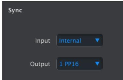
Mit diesen Einstellungen können Sie die Eingänge für den Empfang von Synchronisations- und Tempo-Signalen sowie die Eingangs- und Ausgangs-Clock-Raten festlegen. Durch Ändern dieser Einstellungen bestimmen Sie, welche Art von Clock-Signal über die Ausgangsanschlüsse übertragen wird und was von den Sync/Clock-Eingängen erkannt wird.
