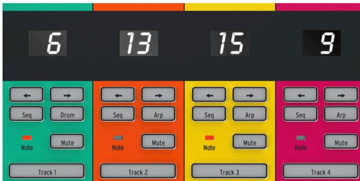
Die Track-Steuerungen sind bis auf einen Taster identisch: Track 1 verfügt über einen Drum-Taster für den Drum-Sequencer, die Tracks 2, 3 und 4 bieten jeweils einen Arp-Taster für die Arpeggiatoren. Es gibt folgende Bedienelemente:
