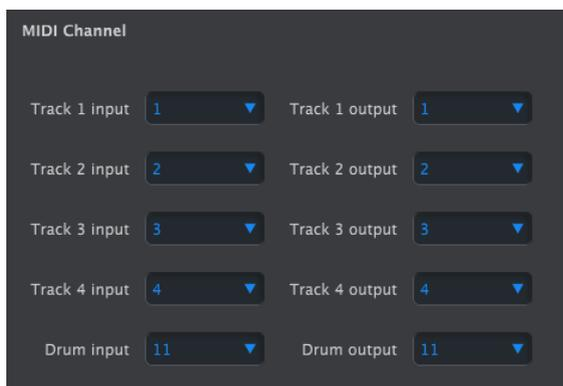
In diesem Menü stellen Sie die globalen Kanäle ein, auf denen die vier Tracks des KeyStep Pro MIDI-Signale senden und empfangen. Die Standardeinstellung der vier Tracks ist identisch mit der Tracknummer (MIDI-Kanäle 1-4); der Drum-Kanal ist standardmäßig MIDI-Kanal 10.
