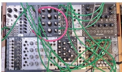
Eine weitere interessante Verwendung des KeyStep Pro ist als Master-Clock für Ihr Eurorack-Modul- oder RackBrute-System. Um dies zu ermöglichen, verfügt das KeyStep Pro über einen Clock-Ausgang. Eine clevere Lösung ist es, den Clock Out des KeyStep Pro mit einem Clock-Divider zu verbinden, der das Tempo in halbe oder noch kleinere Teiler teilt. Mit diesen Zeitsignalen können Sie dann beispielsweise Ereignisse für jeden Beat, alle zwei Beats oder für jeden Takt starten.
