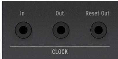
Das KeyStep Pro kann sowohl Synchronisationssignale senden als auch empfangen. Es verfügt auch über einen Reset Out, mit dem externe Sequenzer mit einem Reset-Eingang beim Neustart einer KeyStep Pro-Sequenz vom Anfang einer Sequenz aus neu gestartet werden können.
