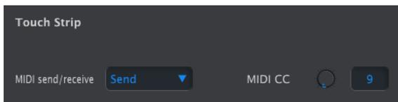
Mit diesem Menüpunkt können Sie die Werte einstellen, die der Looper Touch-Strip bei Berührung empfängt und sendet.
