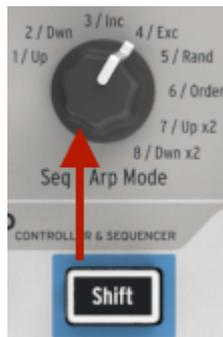
Es ist möglich, zwischen nicht-benachbarten Sequenzen oder Arpeggio-Pattern zu wechseln, ohne beim Drehen des Reglers die dazwischenliegenden Auswahlmöglichkeiten auszulösen. Spielt etwa Sequenz 1 und Sie wollen einen nahtlosen Übergang zu Sequenz 3 erreichen, so ist dies möglich, ohne Sequenz 2 zu starten.
