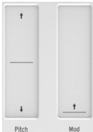
Statt herkömmlicher Räder für Pitchbend und Modulation nutzt das KeyStep innovative Touchstrips. Deren MIDI-Kanäle lassen sich getrennt im MIDI Control Center einstellen. Dem Mod-Strip kann außerdem jeglicher MIDI Continuous Controller Nummer (CC#) zugewiesen werden.
