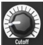
Le potentiomètre **Cutoff** règle la fréquence de coupure du filtre, de moins de 20Hz en position minimale jusqu'à 18kHz en position maximale. Par exemple, en mode **LP** vous pouvez modifier la brillance du son.
