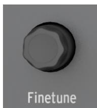
Le potard **Fine Tune** permet un ajustement précis de l'accordage de l'oscillateur. La gamme complète du potentiomètre **Fine Tuning** est d'environ -2 demi-tons à +2 demi-tons. L'accordage fin permet d'accorder le MicroBrute avec d'autres instruments légèrement désaccordés.
