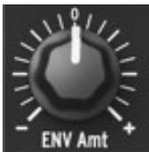
Le potentiomètre rotatif **ENV Amt** permet de contrôler l'amplitude et la polarité du signal d'enveloppe appliqué à la fréquence de coupure du filtre.
