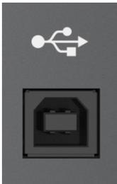
Le port **USB** est l'interface avec un ordinateur. Elle permet la transmission d'évènements MIDI et la communication avec le logiciel de configuration MicroBrute Connection.
