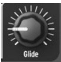
Le potentiomètre **Glide** règle la quantité de *portamento*, c'est-à-dire la durée de transition d'une note à une autre, lorsque celles-ci sont jouées au clavier ou avec le séquenceur.
