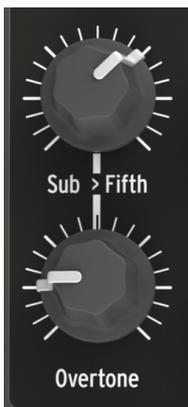
Le volume de l'oscillateur Overtone est réglé par le potard noté **Overtone**. La position basse coupe le signal, en poussant vers le haut on augmente le volume du signal. L'oscillateur Overtone est un signal créé à partir de l'oscillateur principal, mais permet des hauteurs de notes qui vont de l'octave inférieure (sous-oscillateur) jusqu'à une quinte au dessus de la fondamentale de l'oscillateur.
