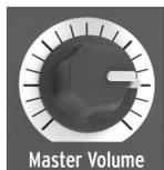
Le potentiomètre **Master Volume** définit le volume général de sortie du MicroBrute, lequel est au niveau ligne standard +4dBu. Pour couper le son du MicroBrute, tournez le potentiomètre au minimum dans le sens antihoraire.
