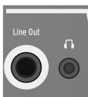
Connectez le jack **Line Out** à un mixeur audio, une carte son d'ordinateur ou directement sur un amplificateur audio à l'aide d'un câble mono 1/4". Vous pouvez connecter un casque à la sortie casque. Le potard **Master Volume** du panel avant contrôle le volume de ces deux sorties.
