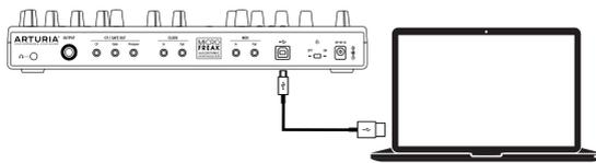
*Conexión de MicroFreak a computadora*
