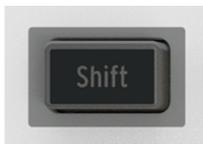
Mit dem Shift-Taster können Sie auf die Sekundär-Funktionen des MicroLab mk3 zugreifen, wie z.B. den Akkordmodus, die Programmwechsel-Befehle und die MIDI-Kanalauswahl. Die Sekundär-Funktionen sind in grauer Schrift unterhalb der Taster und Strips, sowie oberhalb der ersten 16 Keyboard-Tasten der Tastatur aufgedruckt.
