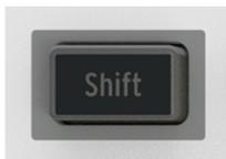
Shift ボタンは、コードモードやプログラムチェンジ、MIDI チャンネル選択などの機能にアクセスするときに使用します。Shift ボタンでアクセスする機能は、本体パネルのボタンやストリップの下、キーボードの最低音から16個のキーの上にグレーの文字で記載されています。
