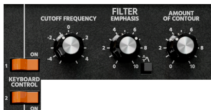
Los controles del filtro, con los interruptores de control del teclado
