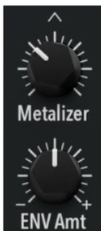
Der Metalizer beeinflusst nur die Dreieckswelle. Er erhöht die Anzahl an höheren und manchmal nichtlinearen Harmonischen in der Wellenform durch einen Prozess, der als *Wavefolding* (Wellenfaltung) bekannt ist. Um zu verstehen, wie das funktioniert, stellen Sie sich eine Standard-Dreieckswelle vor:
