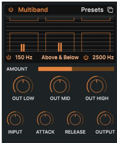
Ein Multiband-Kompressor funktioniert wie eine in Reihe geschalteter normaler Kompressoren, aber jeder arbeitet in einem separaten Frequenzbereich (*Band*). Diese Kompressoren wurden ursprünglich von Mastering-Technikern verwendet, um den maximalen Pegel für Aufnahmen herauszuholen. Heute werden sie für subtile Klangformung, Sounddesign, Spezialeffekte und vieles mehr eingesetzt.
