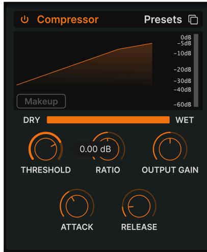
Ein **Kompressor** wird verwendet, um den Dynamikbereich eines Klangs zu steuern: Er verringert den Unterschied zwischen dem leisesten und dem lautesten Pegel, den ein Klang haben kann. Dabei wird die Verstärkung um einen bestimmten Betrag (die Ratio) reduziert, sobald das Audiosignal einen bestimmten Pegel (den Threshold) erreicht.
