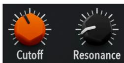
Le potentiomètre **Cutoff** détermine simplement la fréquence à laquelle le filtre commence à réduire le volume des fréquences qui se situent en dehors de la plage autorisée. Dans les modes Lowpass ou Highpass, ces fréquences se situent d'un côté ou de l'autre de la coupure. Dans les modes Bandpass ou Notch, la fréquence de coupure est plus correctement appelée fréquence *centrale*, car le potentiomètre définit le centre de la bande qui passe ou qui est rejetée.
