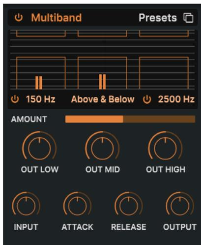
Un compresseur multibande fonctionne comme une série de compresseurs classiques, mais chacun fonctionne sur une plage de fréquences distincte (*bande*). D'abord utilisés par les ingénieurs de mastering pour extraire le maximum de niveau des enregistrements, ces compresseurs sont maintenant utilisés pour la sculpture subtile, la conception sonore, les effets spéciaux et bien plus encore.
