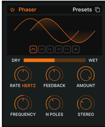
Le déphasage divise le signal entrant, change la phase d'un côté et la recombine avec le signal non affecté. La modulation de ce signal via un LFO induit un filtre en peigne réjecteur qui balaye le spectre de fréquences, entraînant un son « assourdissant » familier.
