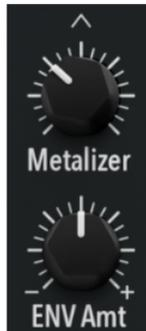
Le Metalizer n'affecte que l'onde triangulaire. Il augmente la quantité d'harmoniques supérieurs et parfois non linéaires dans la forme d'onde par un processus connu sous le nom de *wavefolding* (pliage d'onde). Pour comprendre comment cela fonctionne, visualisez une onde triangulaire standard :
