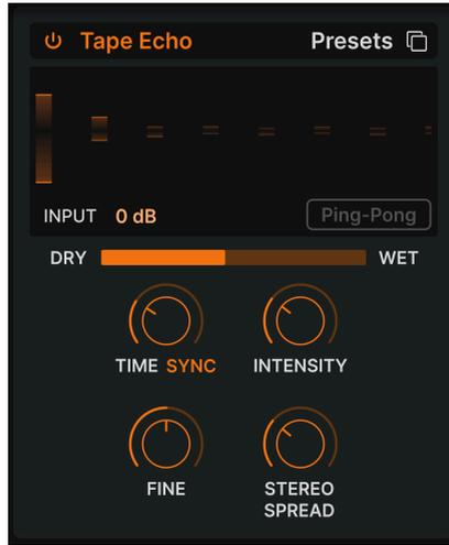
**Tape Echo** est une caractéristique des anciens delays comme le Maestro Echoplex et le Roland Space Echo. Les sons d'entrée sont enregistrés sur une boucle de bande avec une ou plusieurs têtes de lecture pour créer les échos. Comme les boucles de bande peuvent être instables et changer de hauteur et de timbre, elles produisent un effet plus chaud et plus précis qu'un delay numérique.
