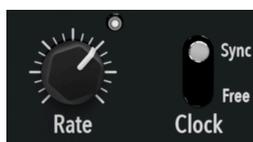
Le LFO de MiniBrute V peut fonctionner librement en Hz ou se synchroniser au tempo défini sur le logiciel hôte.
