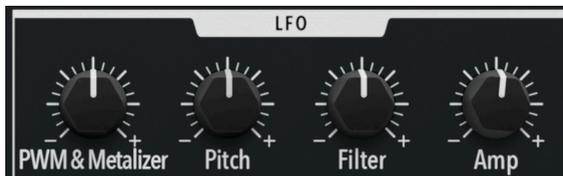
*La rangée supérieure de potentiomètres du LFO ajuste les profondeurs d'une ou de plusieurs destinations*
