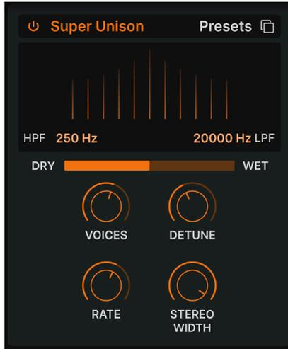
Un peu comme le mode Unison d'un synthé, cet effet ajoute des doubles du signal d'entrée à lui-même, avec la possibilité de les désaccorder. Le graphique affiche la quantité de désaccordage entre les voix (horizontal) et le volume des voix désaccordées (vertical). Le signal original est la ligne la plus haute au centre.
