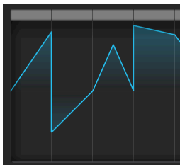
Les quatre types de pentes (Slope) : Rise, (négative) Fall, Triangle et Join
