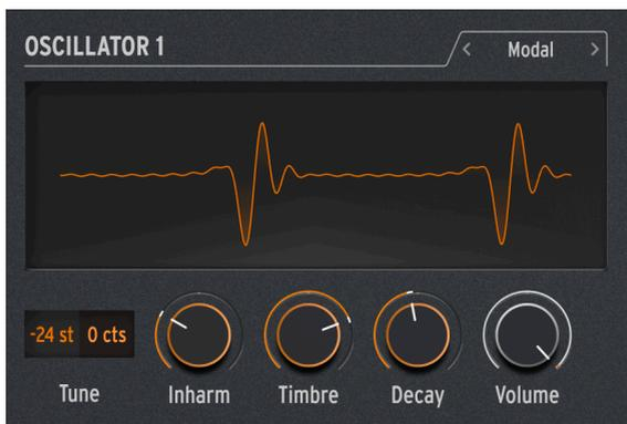
Der Modal-Oszillator bietet eine einfache Möglichkeit, wunderbar klare und realistische Percussion-Klänge zu erhalten. Er basiert auf dem Physical Modeling eines Objekts, das mit einem Energiestoß angeregt wird und dann in Resonanzschwingung gerät - der [KarplusStr-Oszillator \[p.26\]](#) funktioniert auf ähnliche Weise.
