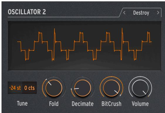
Destroy macht genau das: Es zerstört Ihr eingehendes Signal, indem es dieses drei unerbittlichen Signalprozessen aussetzt: Einem Wavefolder, einem Decimator und einem Bit Crusher. Ach, du liebe Güte!
