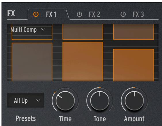
Ein *Kompressor* steuert den Dynamikbereich eines Signals. Ein herkömmlicher Kompressor verhindert, dass laute Signale zu laut werden und ein *Expander* macht Signale mit niedrigem Pegel noch leiser und kann somit Rauschen unterdrücken.
