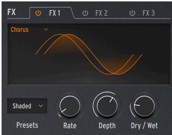
Ein Chorus erstellt aus dem Eingangssignal eine oder mehrere Kopien, jeweils mit einer leichten Zeitverzögerung und ändert dann diese Verzögerungswerte langsam (oder schnell) mit einem LFO. Wenn das Effektsignal mit dem trockenen Signal gemischt wird, erzeugt der Effekt eine breitere, fettere Version des Klangs, die den Eindruck erweckt, man würde mehrere Instrumente gleichzeitig spielen.
