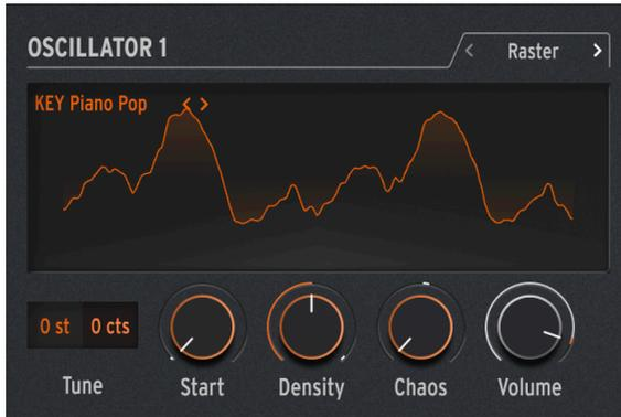
Die Raster-Engine ist auf rhythmischere Ansätze ausgerichtet, wobei die Grain-Generierung zum Tempo synchronisiert wird. Perfekt zum Erstellen von Beat-Repeats/-Chopping und hypnotischen Zufallssequenzen.
