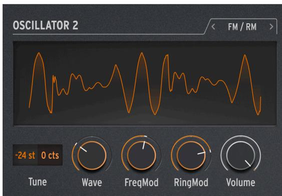
Eine *Frequenzmodulation* (FM) findet dann statt, wenn ein Audiosignal die Frequenz eines anderen moduliert. Eine einfache, aber leistungsstarke Implementierung findet sich im [Two Op. FM-Oszillator \[p.29\]](#). Hierbei moduliert Osc 1 eine von Osc 2 erzeugte Wellenform.
