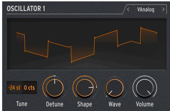
VAnalog ist ein virtuell-analoges Wellenform-Modell. Dieses simuliert zwei analoge Wellenformen – Rechteck und Sägezahn – jede mit sehr variablem Waveshaping.
