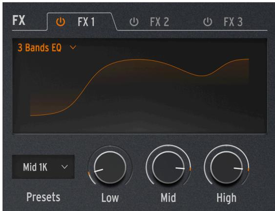
Der Equalizer (EQ) ist eines der klassischen Werkzeuge bei der professionellen Audiobearbeitung. Ein EQ kann den Frequenzgang eines Signals formen, um bestimmte Klangmerkmale hervorzuheben oder andere zu unterdrücken. Dies kann durch Anheben (Verstärken) eines bestimmten Frequenzbereichs oder durch Absenken (Abschwächen) erfolgen.
