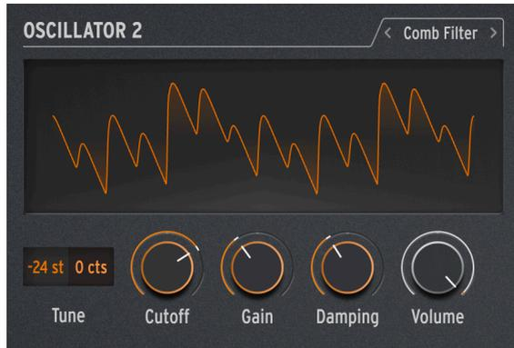
Ein *Kammfilter* verdankt seinen Namen der Tatsache, dass er eine Reihe von gleichmäßigen Kerben im Frequenzgang erzeugt, die wie die Zähne eines Kamms aussehen, wenn sie in einem Diagramm dargestellt werden. Dazu mischt er das Eingangssignal mit einer um einige Millisekunden verzögerten Kopie dieses Signals. Diese beiden Signale werden dann kombiniert und heben sich an den regelmäßigen Frequenzen gegenseitig auf. Das erzeugt einen ausgeprägten und hohlklingenden Charakter.
