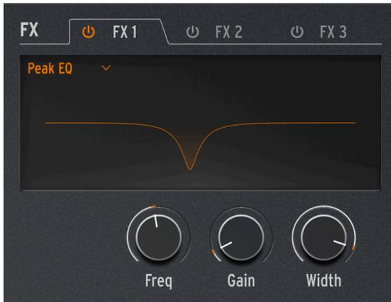
Dieser EQ unterscheidet sich vom 3-Band-EQ dadurch, dass er nur ein EQ-Band nutzt, welches drei zusammenhängende Parameter bietet: **Freq** (Frequenz), **Gain** und **Width** (Filtergüte).
