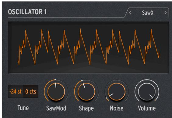
Das SAWX Oszillator-Modell zeigt, dass die gute alte Sägezahnwelle doch noch neue Tricks drauf haben kann. Bei diesem Oszillator wird die Phase einer Sägezahnwelle mit weißem Rauschen moduliert, das in der Abtastrate reduziert und dann mit einem Chorus verstärkt wurde. Dadurch entstehen harmonisch reiche Variationen mit einer Vielzahl unterschiedlicher Charaktere.
