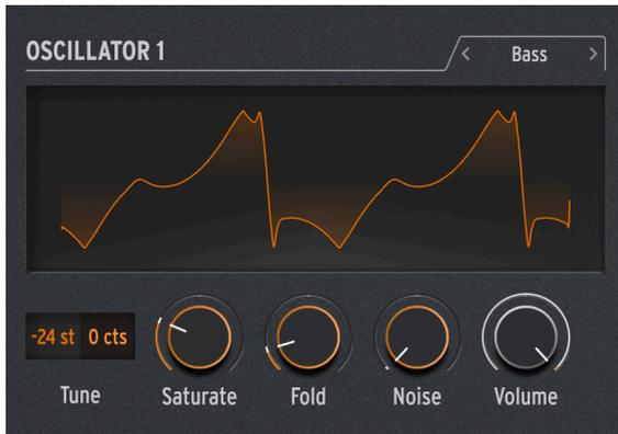
Der BASS-Oszillator erzeugt ein Wellenformpaar – eine Sinuswelle und eine *Kosinus*-Welle (eine Sinuswelle, die in der Phase verschoben wurde, so dass, wenn der Sinus auf 0 ist, der Cosinus auf Maximum oder Minimum steht und umgekehrt). Diese Wellenformen sind in einen Satz von zwei modellierten Schaltkreisen enthalten: Einem symmetrischen Modulator für die Sinuswelle und einen Quadratur-Oszillator, der diese mit der modulierten Kosinuswelle mischt.
