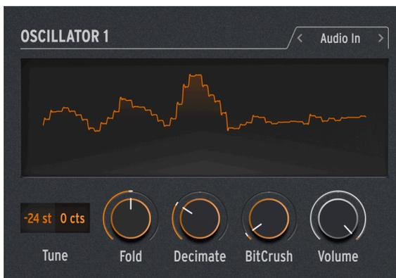
Osc 1 kann jedes Audiosignal vom Sidechain-Eingang in den Signalfluss des MiniFreak V einspeisen. Das Audiosignal wird dann von einem Wavefolder und einem Dezimator verarbeitet, wobei digitales Rauschen hinzugefügt wird.
