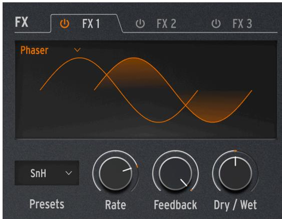
Ein Phaser kombiniert das trockene Signal mit Kopien, deren Phase verschoben wird, indem diese durch eine Reihe von [Allpassfiltern \[p.51\]](#) laufen. Das erzeugt Frequenzkerben, die einen anderen Charakter haben als die gleichmäßig verteilten Anhebungen und Auslöschungen von einem Flanger oder Chorus. Ein LFO steuert das Filterverhalten, um einen langsamen Sweep-Effekt zu erzeugen.
