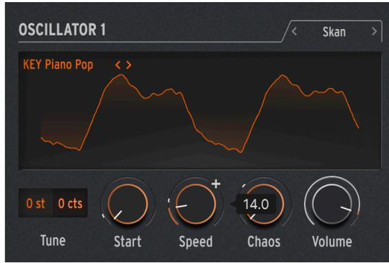
Die Skan-Engine durchsucht das Sample und erzeugt dabei Grains um im Bereich der Wiedergabeposition. Das Abspielen erfolgt von Anfang bis Ende mit einer benutzerdefinierten Geschwindigkeit. Ideal für einen Stretch-ähnlichen Effekt.
