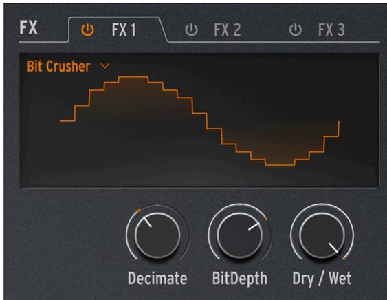
Ein Bitcrusher reduziert die Auflösung eines digitalen Audiosignals beispielsweise von 16 Bit (CD-Qualität) auf 8 Bit (frühere Sampler) oder auf noch niedrigere Werte. Die Bit-Reduktion vermindert die Klarheit und reduziert die Dynamik für einen Sound, der von "vintage" bis "krass" reichen kann.
