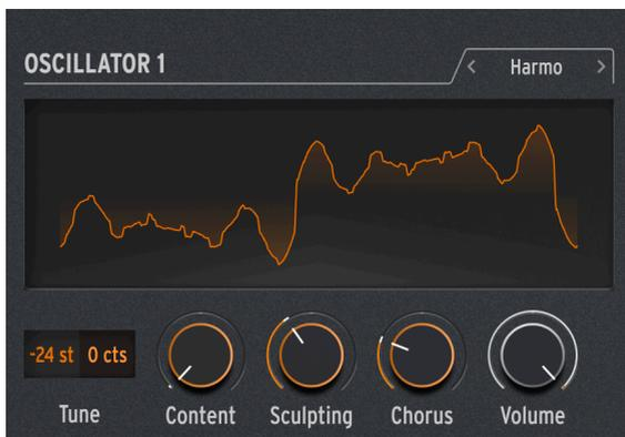
Der Harmonic Oscillator wendet eine Form der *additiven Synthese* an, bei der ein sich entwickelnder Klang aus mehreren *Obertönen* besteht, die mit der Zeit lauter oder leiser werden. Jeder Klang, den wir hören, ob natürlich oder elektronisch, besteht aus einer sehr großen Anzahl von Sinuswellen, die ihre individuelle Lautstärke in Relation zueinander ändern.
