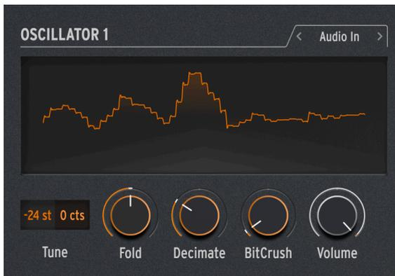
Osc 1 puede enrutar cualquier señal de audio desde el Conector de Entrada de Audio al flujo de señal de MiniFreak. Este audio es digitalizado, luego procesado por una carpeta de ondas y un diezmadador, con ruido digital agregado.
