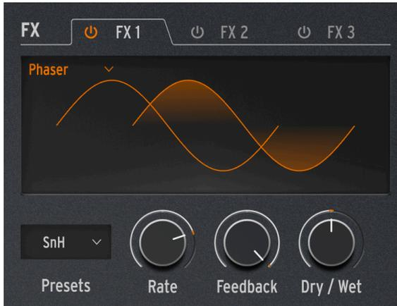
Un modulador de fase combina la señal seca con copias que tienen su fase cambiada al ejecutarlas a través de una serie de [Todos los Filtros de Paso \[p.50\]](#). Esto produce muescas de frecuencia que tienen un carácter diferente al de las ranuras uniformemente espaciadas de un flanger o coro. Un LFO controla el comportamiento del filtro para producir un efecto de barrido lento.
