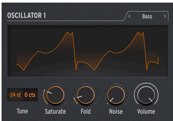
El Oscilador de Bajos modela un par de ondas - una onda sinusoidal y una onda coseno (una onda sinusoidal que se ha movido en fase de modo que cuando el seno está en 0, el coseno está en el máximo o mínimo, y viceversa). Estas ondas se colocan en un conjunto de dos circuitos modelados: un modulador balanceado para la onda sinusoidal y un oscilador en cuadratura que la mezcla con la onda coseno modulada.
