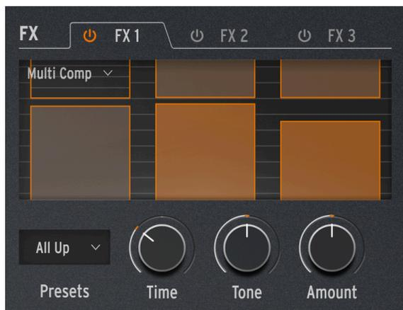
Un *compresor* controla el rango dinámico de una señal. Un compresor tradicional ayuda a evitar que las señales fuertes se vuelvan demasiado fuertes, y un *expansor* fuerza las señales de bajo nivel aún más bajo, suprimiendo el ruido.
