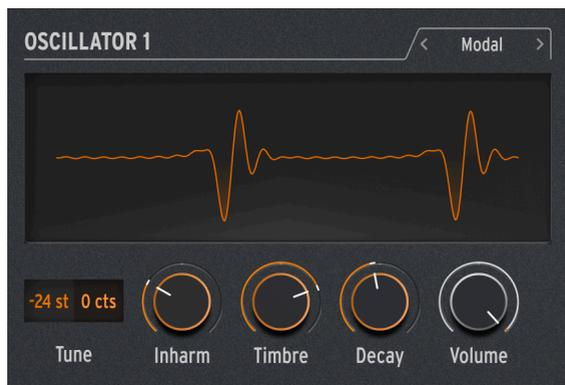
El Oscilador Modal ofrece una forma sencilla de obtener tonos de percusión bellamente claros y realistas. Se basa en el modelado físico de un objeto que se excita con un estallido de energía y luego resuena - el Tipo de Oscilador [Karplus Str \[p.26\]](#) funciona de manera similar.
