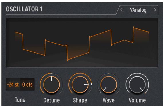
VAnalog es un modelo de forma de onda análoga virtual. Simula dos ondas análogas - pulso y diente de sierra - cada una con una forma de onda muy variable.
