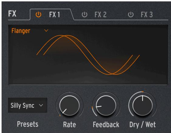
Un flanger crea un intenso efecto de filtro de peine. Funciona de la misma manera que un coro, pero por lo general solamente tiene una señal retrasada para mezclar con la señal seca, y su tiempo de retraso es muy corto, solo unos pocos milisegundos.
