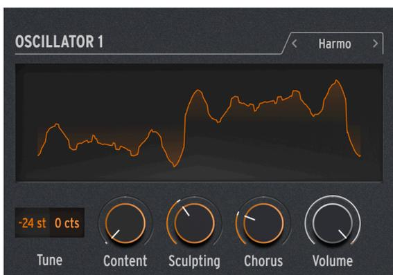
El Oscilador Armónico aplica una forma de *síntesis aditiva*, donde un sonido en evolución se compone de múltiples *armónicos* que se vuelven más fuertes o más suaves con el tiempo. Cada sonido que escuchamos, ya sea natural o electrónico, se compone de una gran cantidad de ondas sinusoidales que cambian en relación a unos con otros.
