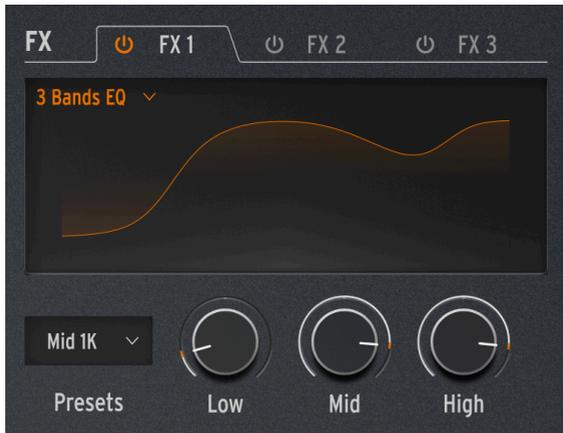
La Ecuilización es una de las herramientas clásicas del audio profesional. Un Ecuilizador puede esculpir la respuesta de frecuencia de una señal para resaltar ciertos rasgos sónicos y suprimir otros. Esto se puede hacer aumentando (amplificando) un determinado rango de frecuencias o recortándolas (atenuándolas).
