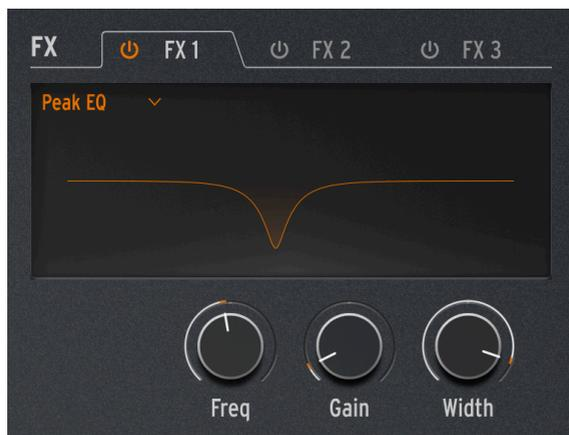
Este Ecuador se diferencia del Tipo anterior en que proporciona controles para una sola banda de ecualizador, pero incluye los tres parámetros comunes: Frecuencia (**Freq**), **Ganancia** y **Ancho**.
