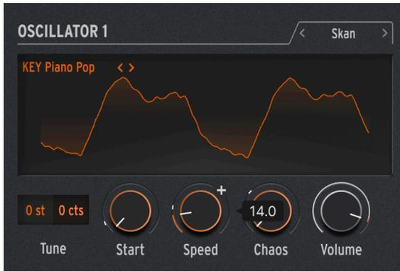
El motor Skan recorre el sample mientras genera granos alrededor del cabezal de reproducción, reproduciéndolo de principio a fin a una velocidad definible por el usuario. Ideal para efectos similares al estiramiento.
