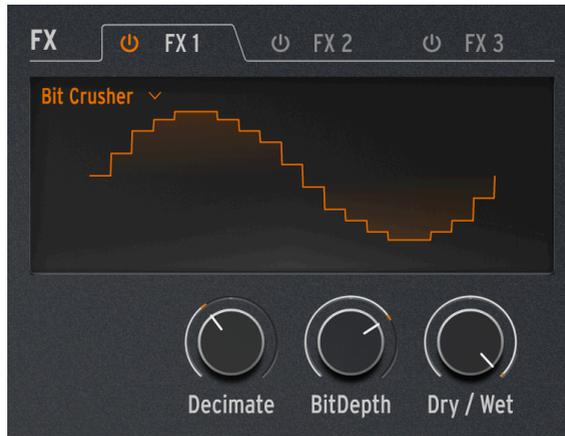
Un bit crusher reduce la resolución de una señal digital, por ejemplo, de 16 bits (calidad de CD) a 8 bits (máquinas de muestras muy antiguas) a números aún más bajos. La reducción de bits elimina la claridad y el rango dinámico, para tonos que van desde "vintage" hasta "repugnante".
