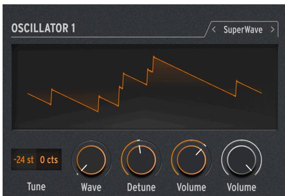
Una de las formas más fáciles de agregar grosor a una forma de onda de sintetizador generada digitalmente es hacer varias copias y desafinarlas entre sí. Originalmente, esto se hizo con ondas de diente de sierra, y la onda Super Saw, pionera del Roland JP-8000, se convirtió en un ícono sonoro.
