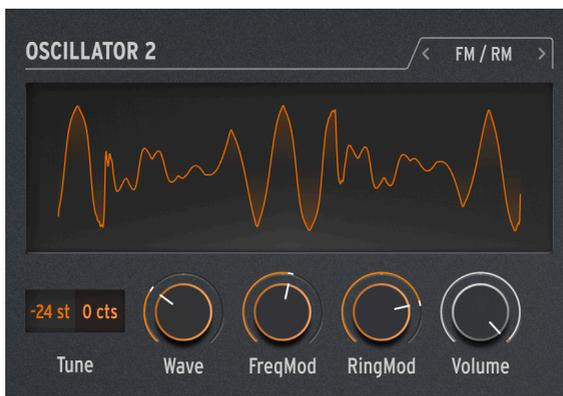
*Modulación de Frecuencia (FM)* ocurre cuando una señal de audio modula la frecuencia de otra. Una implementación simple, pero poderosa, se puede encontrar en [Dos Op. Oscilador FM \[p.28\]](#); aquí, Osc 1 modula una forma de onda generada por Osc 2.
