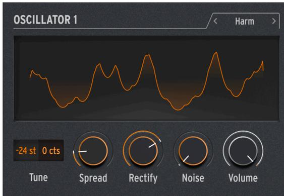
El Oscilador HARM toma una frecuencia fundamental para comenzar y agrega armónicos, usando un modelo diferente al del [Oscilador Armónico \[p.25\]](#).
