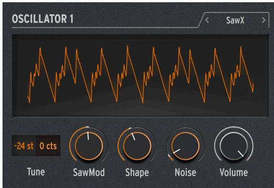
El modelo del Oscilador SAWX demuestra que la buena y antigua onda de diente de sierra todavía puede aprender nuevos trucos. En este oscilador, una onda de diente de sierra tiene su fase modulada con ruido blanco que se ha reducido en la frecuencia de muestreo y luego se ha engrosado con un coro. Esto produce variaciones armónicamente ricas con una variedad de caracteres diferentes.
