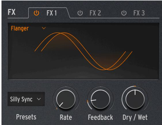
フランジャーは強烈なコムフィルター効果を作り出します。動作原理はコーラスと同じですが、通常はドライ音とミックスするディレイがかかった信号は1つで、そのディレイタイムはわずか数ミリ秒と非常に短い設定です。
