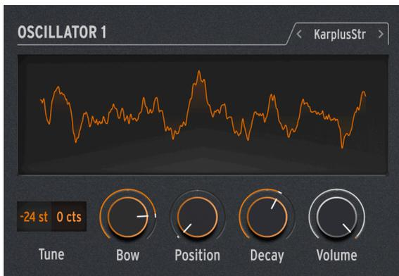
Karplus-Strong オシレーター音源は、音源としては最初期の フィジカルモデル の1つです。スタンフォード大学の Kevin Karplus と Alex Strong が開発したシンセシス方式で、フィルターディレイがかかった短いノイズバーストをループさせ、弦を弾いたり擦ったりする音(撥弦、擦弦)や、打楽器のヘッド(皮)を叩く音のリアルなモデルを作ることができます。弓が弦の、叩くことがドラムヘッドの振動を起こすというように、エキサイターと レゾネーターの2つの組み合わせにより音を作ります。
