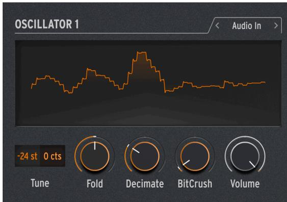
Osc 1 では Audio In 端子から入力したオーディオ信号を MiniFreak の シグナルフローに取り込むことができます。入力したオーディオ信号はデジタル変換され、ウェーブフォルダーとデシメーターで加工され、デジタルノイズをミックスすることもできます。
