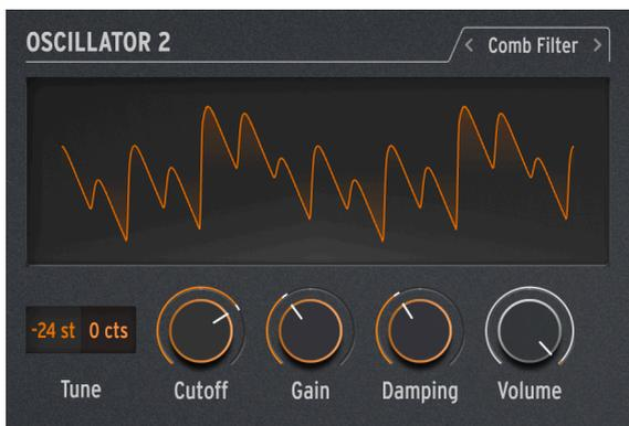
コムフィルターは、周波数特性に均等間隔でノッチ（大きくカットされた部分）が生じ、それをグラフ化すると櫛の歯のように見えるため、この名が付けました。入力信号をコピーし、そのコピーした信号に数ミリ秒だけ遅延をかけ、元の音とミックスするとほぼ均等な間隔の帯域で干渉が起きてその部分が大きくカットされます。これにより、非常に特徴的な音色になります。
