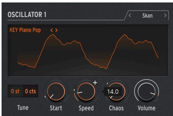
Skan エンジンは、再生ヘッド付近でグレインを生成させつつサンプルをスキャンし、サンプル全体をスキャンする速度を設定できます。ストレッチ的な効果を出すのに適しています。
