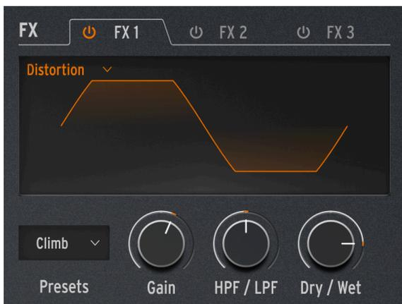
「ディストーション」という言葉には色々な範囲がありますが、一般的には入力信号の振幅が回路の許容範囲を超えるほど大きすぎて、波形の上端と下端が「切り落とされる」クリッピングした状態を指します。こうした現象は、様々な種類のアナログ回路をオーバードライブさせたときや、アナログテープの信号飽和、あるいはウェーブフォルディングなど色々なデジタル処理でも見られます。またその程度も色々で、音にちょっとした温もりをプラスするもの、ザラツとした質感にするものから、完全に歪んで狂ったようなカオスになるものもあります。
