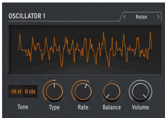
ノイズは多くの音で非常に重要な要素です。幅広い周波数スペクトラムがあり、音のアタック部分にザラツとした質感を持たせたり、風や波の音といった効果音など、色々な用途に応用できます。MiniFreak の Noise オシレーターは、サンプリングのノイズの非常に小さな断片のサンプルレートを下げて作る パーティクルノイズを含む幅広いノイズタイプを作ることができます。
