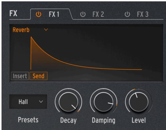
リバーブは、部屋のような空間から大聖堂の中など、残響音をシミュレートした空間に音を入れて音に存在感を出すエフェクトです。残響音はその空間の特性によって様々に変化し、聴感上の空間容積や壁面の吸収性などが変化します。
