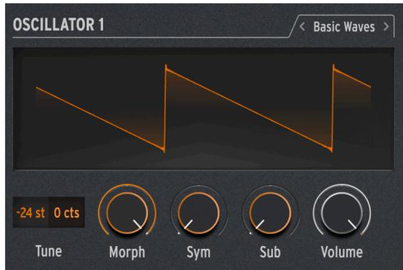
このタイプはトラディショナルなアナログシンセサイザーの2つの波形、ノコギリ波と矩形波のキャラクターをブレンドしています。シンプルながらも豊かな倍音の BasicWaves で、初期のモジュラーシンセサイザーのオシレーター挙動を再現できます。
