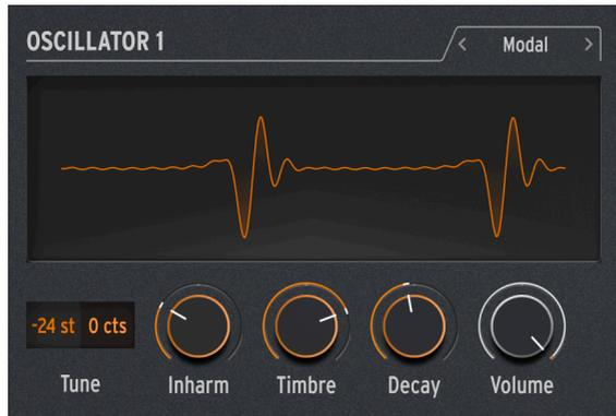
Modal はシンプルな操作で美しくクリアで、リアルなパーカッショントーンを作るオシレーターです。技術的には、エネルギーの入力により発生する振動を共鳴させるというフィジカルモデリングを応用したもので、[Karplus オシレーター \[p.24\]](#)と同様の手法です。
