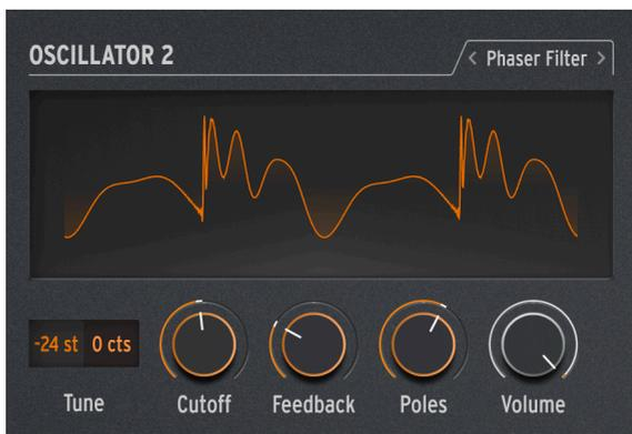
フェイズシフター (別名 フェイザー) もコムフィルター効果を利用したのですが、音のキャラクターは別です。フェイザーでは、入力音に一連の オールパスフィルター を通します。このフィルターはどこかの周波数帯域をカットするためのものではなく、信号の位相を変える働きがあります。位相が変化した信号と元の信号をミックスすると、周波数特性上に不均等な間隔でノッチが生じます。オールパスフィルターの数を増やす (ポールとか ステージ数と言います) と、ノッチの数が増えます。
