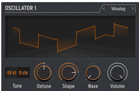
VAnalog はバーチャルアナログの波形モデルで、2つのアナログ波形 (パルス波とノコギリ波) をシミュレートし、どちらも波形を大きく変化させることができます。
