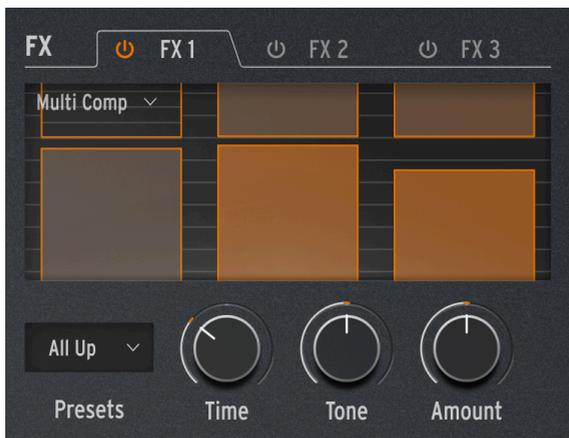
**コンプレッサー** は信号のダイナミックレンジをコントロールするエフェクトです。トラディショナルなコンプレッサーは、音量の大きな信号を過大になるのを防ぐのに便利で、**エキスパンダー** はレベルの低い信号をさらに小さくし、**ノイズ**などを抑えるのに便利です。
