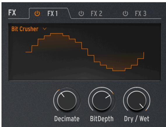
ビットクラッシャーは例えば、16ビット (CD クオリティ) の信号を8ビット (黎明期のサンプラー) やさらに低いビット数というように、入力信号 (デジタル信号) の解像度を落とすエフェクトです。ビット数が下がると音の明瞭度やダイナミックレンジが失われていき、その程度によってビンテージ的な雰囲気にもなりますし、おぞましいほど音が破壊されたような状態にもなります。
