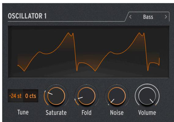
BASS オシレーターは、サイン波と コサイン波 (サイン波が 0 のときにコサイン波が最大または最小、またはその逆になるサイン波) という2つの波形のモデルです。この2つの波形を平衡変調器と、変調されたコサイン波をミックスする直交変換オシレーターという2つの回路モデルに送ります。
