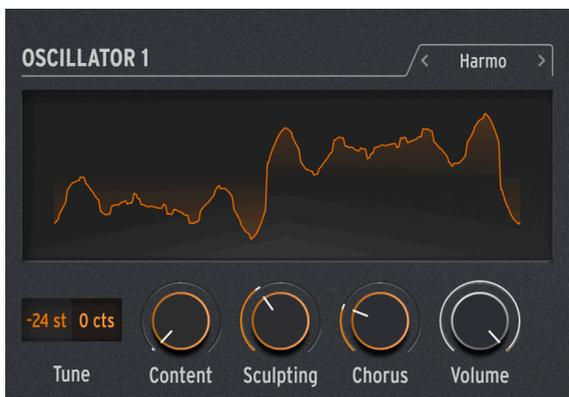
ハーモニックオシレーターは、色々な倍音の時間的な音量変化で音色を作り出す アディティブシンセシス (加算合成方式) のオシレーターです。このオシレーターでは、ナチュラルな感じな音でも、電子的な感じな音でも、その音はそれぞれの音量が変化する膨大な数のサイン波でできています。
