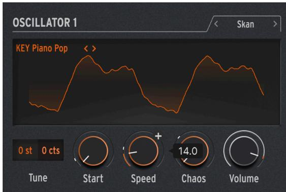
Skan エンジンは、再生ヘッド付近でグレインを生成させつつサンプルをスキャンし、サンプル全体をスキャンするスピードを設定できます。ストレッチ的な効果を出すのに適しています。
