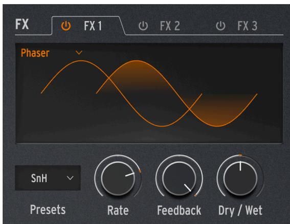
フェイザーは、入力信号のコピーを作り、コピーした信号に一連のオールパスフィルター [p.48]を通して位相を変化させるというエフェクトです。これにより、均等な帯域間隔でノッチが発生するフランジャーやコーラスとは異なり、色々な帯域にノッチが発生する独特の音色になります。LFO でフィルターの動作をコントロールすることでノッチの帯域が徐々に変化していくスイープエフェクトになります。
