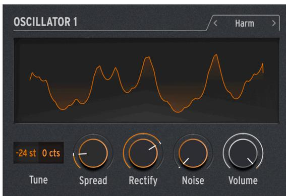
L'oscillateur HARM part d'une fréquence fondamentale et ajoute des harmoniques, en utilisant un modèle différent de celui de l'[oscillateur Harmo \[p.17\]](#).
