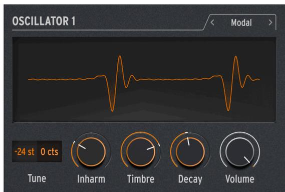
L'oscillateur Modal offre un moyen simple d'obtenir des sons de percussion magnifiquement clairs et réalistes. Il s'appuie sur la modélisation physique d'un objet qui est excité par une introduction d'énergie et qui résonne ensuite ; le type d'oscillateur [KarplusStr \[p.18\]](#) fonctionne de manière similaire.
