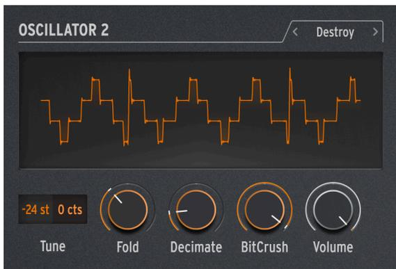
Destroy porte bien son nom : il détruit votre signal entrant en le soumettant à trois processus de traitement de signal scandaleux : un wavefolder, un decimator et un bit crusher. Oh, la douleur !
