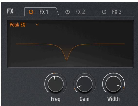
Cet EQ diffère du Type précédent dans le sens où il fournit des contrôles pour une seule bande d'EQ, mais inclut trois des paramètres communs : Frequency (**Freq**), **Gain** et **Width**.
