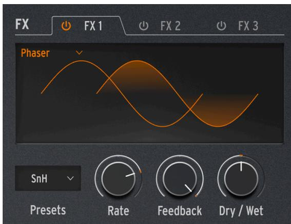
Un Phaser combine le signal Dry avec des copies qui sont déphasées par leur passage par une série de [Filtres passe-tout \[p.42\]](#) (All Pass). Cela produit des crans de fréquence ayant un caractère différent de ceux d'un flanger ou d'un chorus qui sont régulièrement espacés. Un LFO contrôle le comportement du filtre pour produire un effet de balayage lent.
