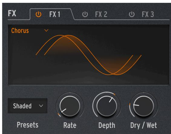
Un chorus prend le signal d'entrée et en fait une ou plusieurs copies, chacune avec un léger temps de delay, puis modifie lentement (ou rapidement) ces quantités de delay avec un LFO. Lorsqu'il est combiné à un signal dry, l'effet est une version plus large et plus épaisse du son, version qui donne l'impression de plusieurs instruments jouant en même temps.
