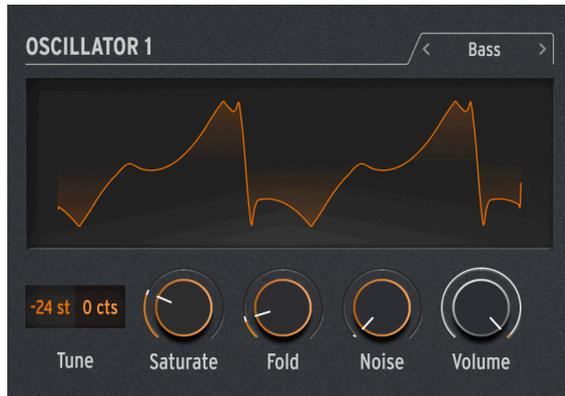
L'oscillateur Bass modélise une paire d'ondes : une onde sinusoïdale et une onde *cosinusoidale* (une onde sinusoïdale déphasée de sorte que lorsque la sinusoïdale est à 0, la cosinusoidale est au maximum ou au minimum, et vice versa). Ces ondes sont placées dans un ensemble de deux circuits modélisés : un modulateur équilibré pour l'onde sinusoïdale et un oscillateur en quadrature qui la mélange avec l'onde cosinusoidale modulée.
