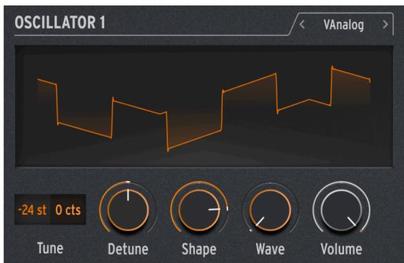
VAnalog est un modèle de forme d'onde analogique virtuel. Il simule deux ondes analogiques (impulsion et dent de scie), chacune avec une forme d'onde très variable.
