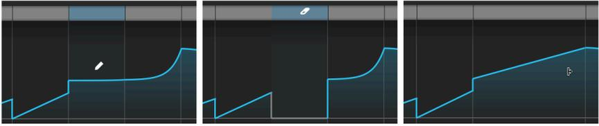
De G à D : Crayon (ajuster l'amplitude), Gomme (effacer le pas), et Suiveur (créer un segment).
