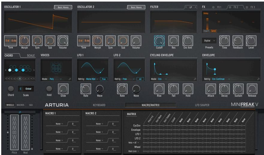
Sélectionnez une destination de ligne de Mod ici (Cutoff est actuellement sélectionné)
