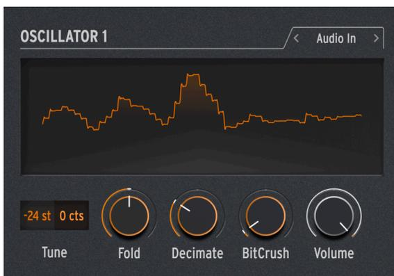
Osc 1 peut router n'importe quel signal audio provenant de la prise Audio In vers le flux de signaux du MiniFreak. Cet audio est numérisé, puis traité par un wavefolder et un décimateur, avec ajout de bruit numérique.
