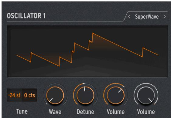
L'un des moyens les plus simples d'ajouter de l'épaisseur à une forme d'onde de synthétiseur générée numériquement est d'en faire plusieurs copies et de les désaccorder les unes des autres. À l'origine, cela se faisait avec des ondes dent de scie, l'onde Super Saw du Roland JP-8000 étant devenue une icône sonore.
