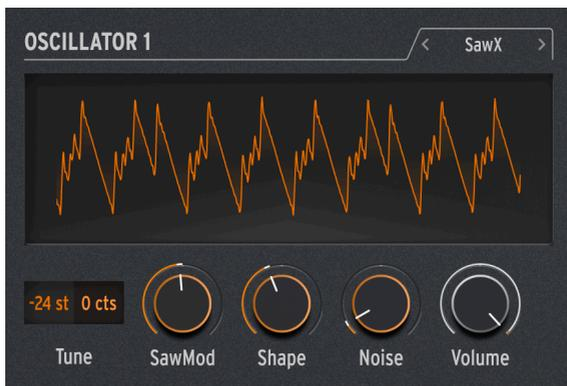
Le modèle d'oscillateur SawX démontre que la bonne vieille onde dent de scie peut encore apprendre de nouveaux trucs. Dans cet oscillateur, une onde dent de scie voit sa phase modulée par un bruit blanc dont la fréquence d'échantillonnage a été réduite, puis épaissie par un chorus. Cela produit des variations harmoniquement riches avec une variété de caractères différents.
