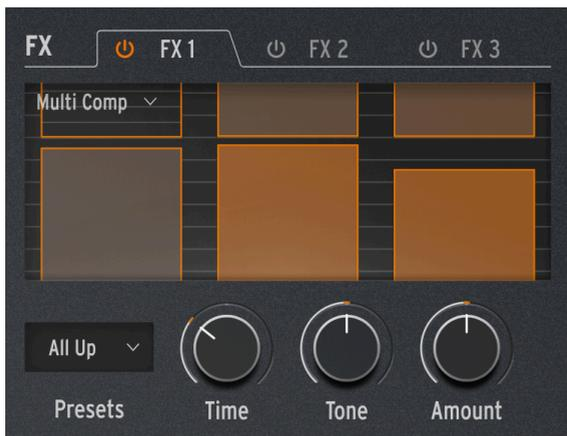
Un *compresseur* contrôle la plage dynamique d'un signal. Un compresseur traditionnel permet d'éviter que les signaux forts ne deviennent trop forts, et un *expandeur* fait baisser encore plus les signaux de faible niveau, en supprimant le bruit.
