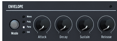
Les contrôles de la partie Envelope
