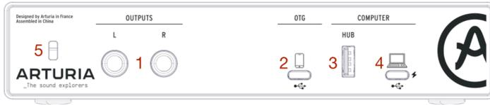
1) Die symmetrischen Left und Right 6.25mm TRS-Klinken-**Ausgänge** können direkt mit aktiven Studiolautsprechern oder anderen Geräten wie Verstärker und Mischpulten verbunden werden. Der Ausgangspegel wird mit dem großen Monitor-Pegelregler auf der Vorderseite eingestellt.
