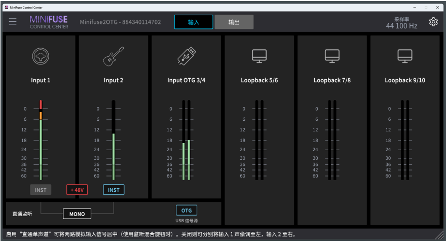
输入选项卡，显示物理输入与环回输入的电平计量
