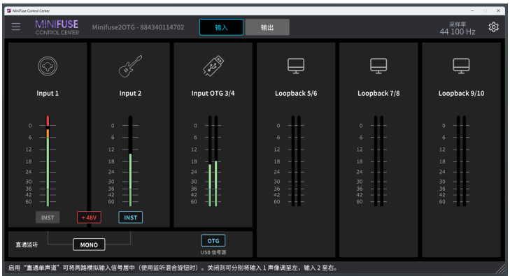
Windows 中的输入选项卡，显示物理输入、OTG 输入以及环回输入的电平计量，这些信号随后将被发送至其关联的输出端（具体说明请参阅《环回录制》章节）。
