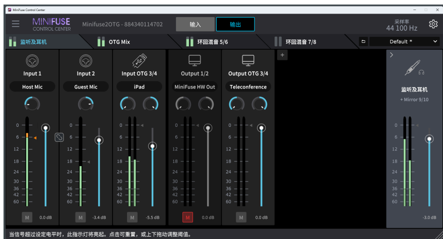
两路麦克风混音通过环回 9/10 发送至数字音频工作站的示意图
