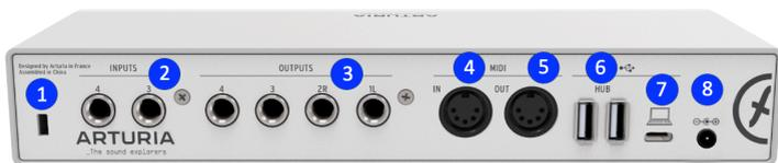
1. **Kensington lock** - ce verrou de sécurité optionnel peut être utilisé pour sécuriser l'interface à l'aide d'un câble Kensington lock.
