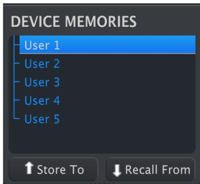
デバイスメモリー画面には5つのメモリーロケーションがあります。この5つは、MiniLab 3 本体内のユーザープログラムメモリーに対応しています。各デバイスメモリー/ユーザープログラムには、MiniLab 3 のノブやフェーダー、パッド、タッチストリップのマッピング情報である [コントローラーマッピング](#) [p.10] のセットが入っています。ユーザープログラムは、[デバイス設定](#) [p.22] で個別にオンにすることができます。MiniLab 3 の **Shift** ボタンを押しながら、使用したいプログラム ("User1"、"User2" など) がディスプレイに表示されるまでパッド 3 を押しすとオンになっているプログラムを呼び出すことができます。
