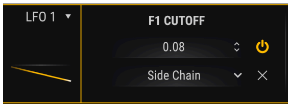
LFO 1 moduliert den Cutoff von Filter 1
