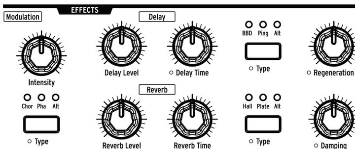
La [partie Effets \[p.88\]](#) peut ajouter du mouvement et de l'ambiance à n'importe quel patch. Même les patches initialisés sont géniaux ! Il vous suffit d'augmenter le potentiomètre Modulation Intensity pour ajouter du chorus, d'augmenter les niveaux de Delay et de Reverb selon vos goûts, et d'apprécier.
