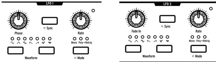
Les LFO 1 et 2 sont identiques, à l'exception d'un potentiomètre dans chaque module : Phase (LFO 1) et Fade In (LFO 2). Voici ce que les contrôles font :
