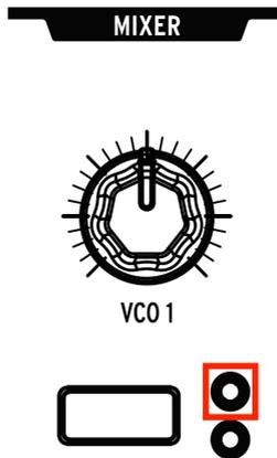
Dans la partie Mixer, appuyez plusieurs fois sur le bouton VCO 1 Filter jusqu'à ce que la LED « Steiner » s'allume. Le VCO 1 est maintenant routé au filtre Steiner.
