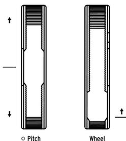
Le PolyBrute offre un ensemble de molettes de pitch bend et de modulation. Elles servent souvent à animer un solo, à aider à l'émulation des instruments acoustiques ou à faire des choses que d'autres instruments ne peuvent pas faire. La molette Pitch revient à la position centrale/zéro, tandis que la molette « Wheel » reste en place.
