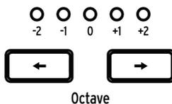
Servez-vous d'[Octave < / >] pour transposer le clavier par octaves. Pour étendre sa plage à un total de neuf octaves. La transposition se fait localement et en MIDI.
