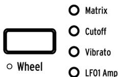
Appuyez sur le bouton Wheel de façon répétée pour sélectionner l'assignation de la molette « Wheel » :
