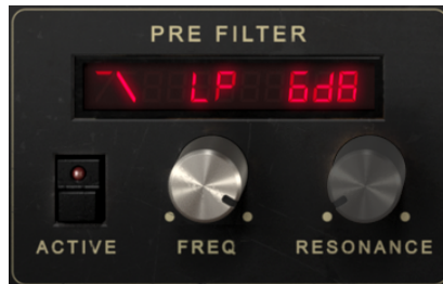
Controles de la sección de pre filtro de Rev Spring-636. El interruptor activo muestra que la sección está apagada
