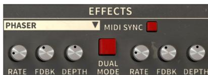
**Rate** : contrôle la vitesse du balayage. Si le bouton MIDI Sync est enfoncé, la quantité de Rate est exprimée en fractions du tempo (de Tempo/15 à Tempo/2) ou en valeurs de notes (1/8 ou 1/4). Les deux types de réglages sont accessibles à partir du même bouton : tourné à gauche pour les divisions de tempo et à droite pour les notes.
