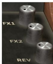
**FX1, FX2 et Rev** : contrôlent les niveaux relatifs des deux processeurs d'effets et la Reverb, qui sont aussi accessibles depuis le panneau Avancé.
