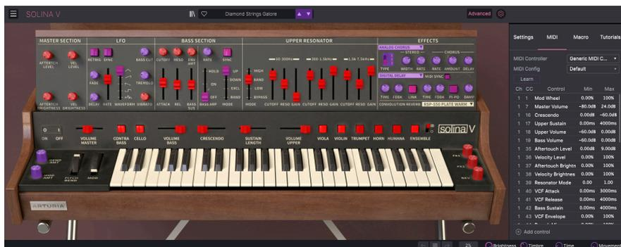
Cliquez sur un contrôle violet et son nom apparaîtra dans la liste. Puis, manipulez un contrôle ou faites fonctionner un interrupteur sur votre contrôleur MIDI. Le contrôle à l'écran correspondant deviendra rouge et le numéro de CC MIDI assigné apparaîtra dans la liste à gauche du nom du paramètre.
