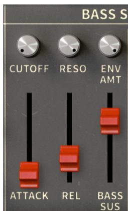
Le côté gauche de la Bass Section ajoute des contrôles pour un filtre résonant avec des paramètres d'enveloppe simples pour la fréquence de coupure et le niveau.
