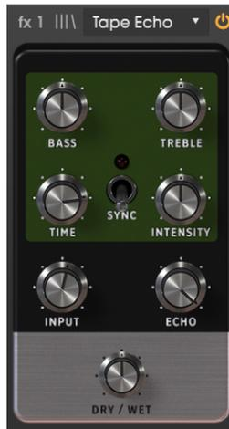
La pédale Tape Echo est une recreation d'un célèbre appareil d'écho à bande des années 1970 et 1980, qui fonctionnait en enregistrant des extraits de l'entrée audio sur une bande magnétique, puis en les lisant avec un retard. En raison de la nature de la bande magnétique, un effet de saturation naturelle de la bande est transmis aux retards.
