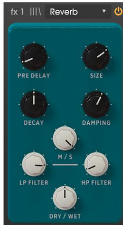
La pédale Reverb vous permet de placer le son dans un espace virtuel. Il s'agit d'une réverb algorithmique, contrairement au module Room à la fin de la chaîne d'effets qui est à convolution. Cependant, cette Reverb peut être placée n'importe où dans la chaîne du signal, afin que d'autres effets puissent être appliqués au son après avoir été traités par la réverb.
