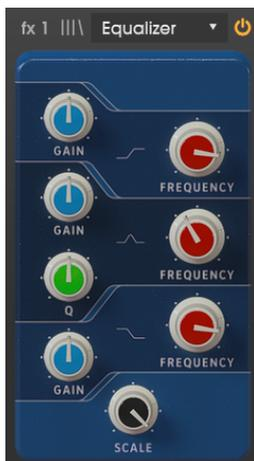
Un égaliseur est une banque de filtres où chaque filtre fonctionne dans une bande spécifique du spectre de fréquences, en augmentant ou réduisant ces fréquences pour modifier l'équilibre général du spectre. Il peut servir pour des réglages sonores subtils, ou pour accentuer certaines bandes et leur permettre de passer au travers du mix.
