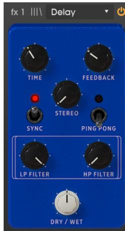
Delay ajoute de la dimension et de l'espace au signal, en créant des échos pouvant être répartis sur l'image stéréo. En utilisant des temps de retard plus longs, cela peut aussi ajouter une qualité rythmique au son, surtout en travaillant avec des sons qui ont une attaque plus prononcée.
