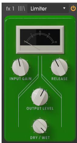
Le Limiter est un type de compresseur qui a une fonction bien précise. Il fonctionne essentiellement comme un « plafond » de volume pour empêcher le signal de dépasser un certain volume. Il est particulièrement utile en travaillant avec des sons qui ont une large plage dynamique et de nombreux effets qui pourraient potentiellement saturer le signal et provoquer des bruits parasites.
