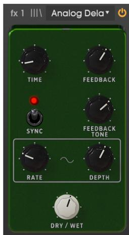
Analog Delay est un autre type de pédale de delay avec un son légèrement différent. Le principe est le même : l'audio d'entrée est enregistré et lu après un petit laps de temps. Un circuit de rétroaction introduit ensuite d'autres copies de l'audio retardé dans le signal d'origine.
