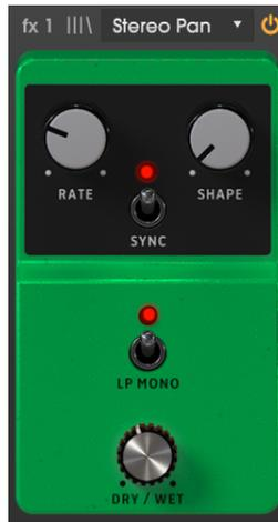
La pédale Stereo Pan peut servir à ajouter un mouvement stéréo au son. Elle se sert d'un LFO (low frequency oscillator - oscillateur basse fréquence) pour faire rebondir le son entre le canal gauche et droit pour créer une sensation de mouvement.
