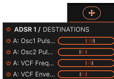
Eine ADSR, welche der Pulsbreite beider Oszillatoren sowie der Frequenz und Hüllkurve des Filters zugewiesen ist, alles innerhalb von Layer A
