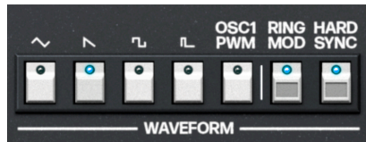
Ring Mod et Hard Sync actifs sur l'Oscillator 2
