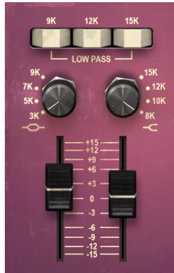
TridAシングルチャンネルEQ のアップパーバンド（ハイシェ ルフとハイミッドレンジ・ベ ル）と3つのローパスフィル タースイッチ
