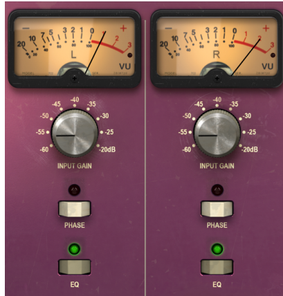
TridAのダブルチャンネル・プリアンプセクションとグローバルフェイズ&EQスイッチ
