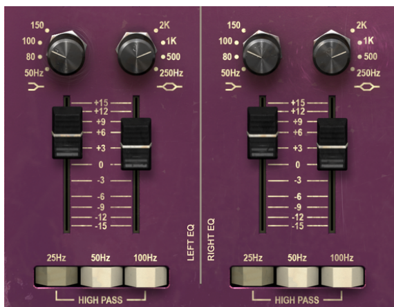
TridAダブルチャンネルEQの低域（ローシェルフとローミッドレンジ・ベル）と3つのハイパスフィルター・スイッチ
