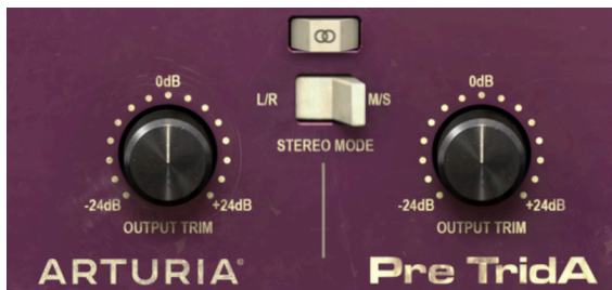
TridAダブルチャンネルのアウトプットトリム・ノブとスイッチを使用してダブルチャンネルの動作（ステレオリンクとステレオモード）をコントロール
