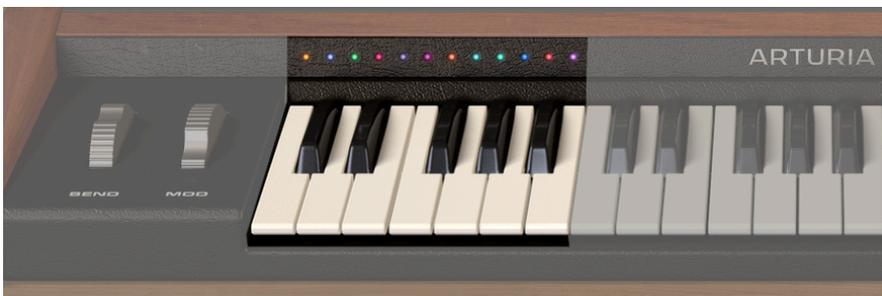
Wenn Sie den Sample Player im Keyboard-Modus verwenden, ist die C1-Oktave (die unterste Oktave auf dem virtuellen Keyboard) für die Wiedergabe von Samples entweder über das Keyboard oder durch MIDI-Daten reserviert. Die farbigen Punkte über den Tasten entsprechen den Sample-Farben im Sample Player. Mit dem Voice Input oder dem Sample-Player im Cycle-Modus spielen diese Tasten wie die anderen Keyboardtasten normale Tonhöhen.
