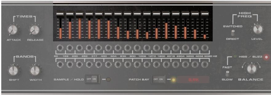
Die 16 Schieberegler steuern die Ausgangspegel der jeweiligen Bänder des Carrier-Synthesizers. Verwenden Sie diese Funktion, um die Pegel von Bändern zu verringern, deren Frequenzen mit anderen Instrumenten in Konflikt stehen oder um die Pegel der Bänder zu erhöhen, die zur Verbesserung der Verständlichkeit beitragen.
