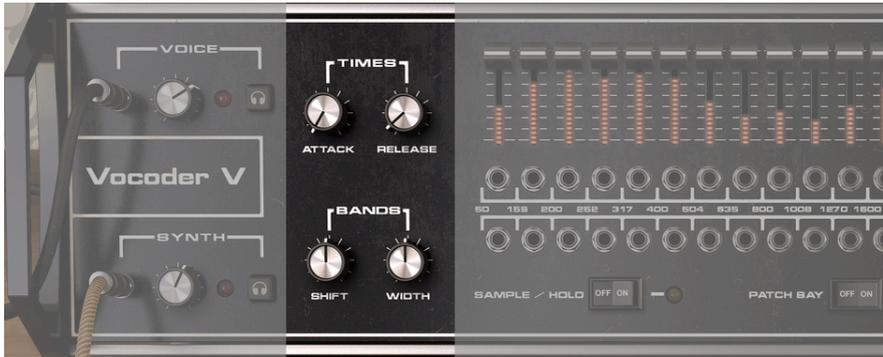
Die Times-Bedienelemente beeinflussen, wie die Hüllkurve des Modulators die entsprechenden Bänder steuert.
