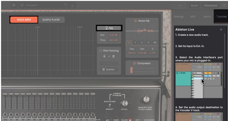
Unterschiedliche DAWs bieten unterschiedliche Möglichkeiten, Signale von einer DAW-Spur oder einem Bus weiterzuleiten. Klicken Sie auf die Help-Schaltfläche, um Anleitungen zum Routing von unterstützten DAWs zu erhalten.
