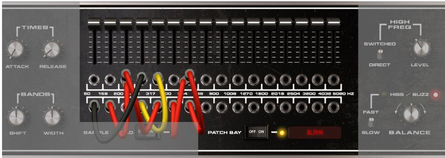
Die Patch-Bay ermöglicht kreative, innovative Vocoder-Effekte. In einem Standard-Vocoder steuert ein Modulatorband das gleiche ihm zugewiesene Frequenzband für den Carrier. Mittels der Patch-Bay können die Analysesignale von jedem Modulator-Band (die obere Reihe der Buchsen) Signale liefern, um die Bänder des Carrier-Synthesizers (die untere Reihe der Buchsen) beliebig anzusteuern.
