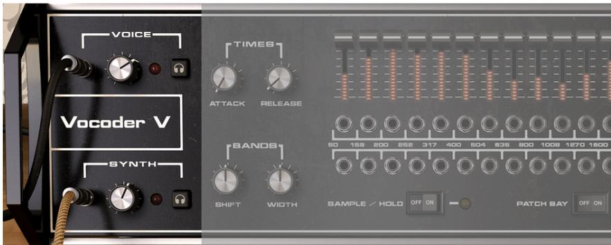
Um die Pegel im Vocoder anzupassen, verfügen sowohl der Modulator (Voice) als auch der Carrier (Synth) über Pegelregler mit einem Verstärkungsbereich von -75 dB bis 0 dB. Stellen Sie die Pegel nicht zu niedrig ein, aber vermeiden Sie es, dass die rote Clipping-Anzeige rechts von den beiden Pegelreglern aufleuchtet.
