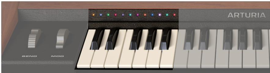
Jedes Sample ist einer Note zugeordnet, wobei ein farbiger Punkt über der entsprechenden Taste der Farbcodierung des Samples entspricht. Beachten Sie in den beiden obigen Abbildungen, wie die farbigen Punkte auf dem Keyboard den Sample-Farben entsprechen.
