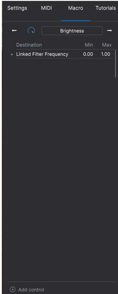
Um einem Makro ein Steuerelement hinzuzufügen, klicken Sie unten im Fenster auf *+ Add Destination*. Klicken Sie dann auf einen lila angezeigten Fader, Drehregler oder Schalter. Stellen Sie den gewünschten Regelbereich ein, indem Sie mit der Maus in die Felder Min und Max klicken und ziehen oder den gewünschten Wert eingeben. Wenn Sie an einem der Makro-Steuerelemente in der unteren Symbolleiste drehen, werden alle verlinkten Steuerelemente entsprechend mitbewegt. Sehr praktisch!
