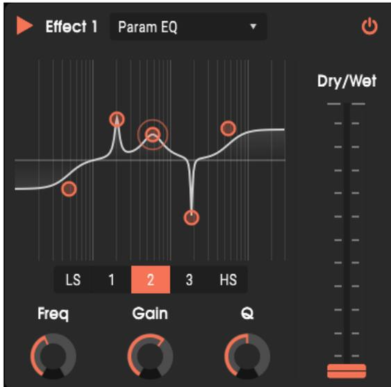
Ein Equalizer (EQ) verstärkt oder dämpft selektive Frequenzen im Frequenzspektrum. Mit einem parametrischen EQ können Sie den Bereich einstellen, der von den Frequenzbändern (d.h. Q oder Filtergüte) beeinflusst wird. Viele parametrische EQs bieten lediglich einfache Shelving-EQs für den tiefsten und den höchsten Frequenzbereich. Mit dem Vocoder V können Sie jedoch die Filtergüte (Q) für alle 5 Frequenzbänder einstellen.
