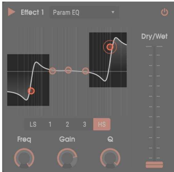
Wenn Sie mit dem Low Shelf absenken oder mit dem High Shelf anheben, fügt Q vor der Grenzfrequenz einen Cut und danach einen Boost hinzu. Wenn Sie mit dem Low Shelf anheben oder mit dem High Shelf absenken, fügt Q vor der Grenzfrequenz einen Boost und danach einen Cut hinzu. In der Abbildung oben ist Q sowohl für den Low Shelf (links) als auch den High Shelf (rechts) aufgedreht – beide schneiden bzw. verstärken.
