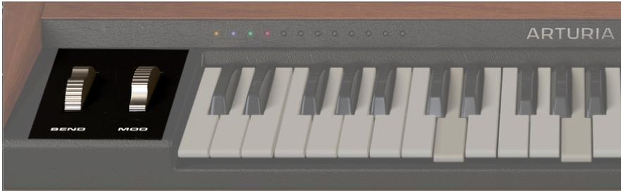
**Bend** ist eine Standard-Pitch-Bend-Steuerung, die mit dem Bend Range-Regler (wird später beschrieben) eingestellt wird.
