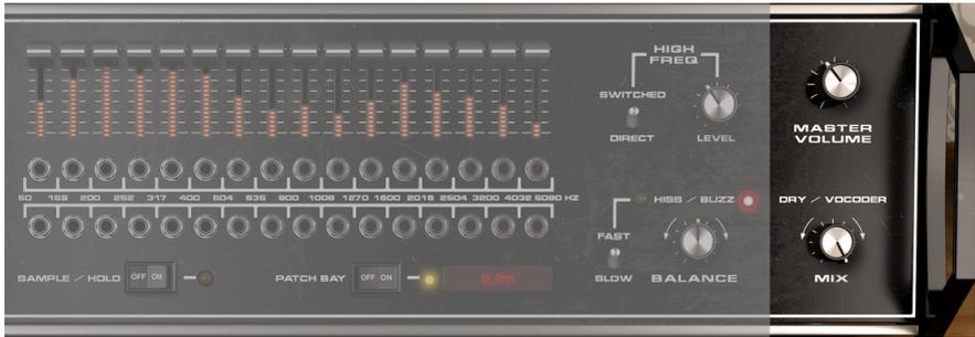
Es handelt sich hierbei um Post-Vocoder-Bedienelemente, die sich auf den Signalausgang auswirken, der dann in die nächsten Systemkomponenten gesendet wird (Kanal-Fader, ein anderes Plug-In, Bus-Eingang usw.).
