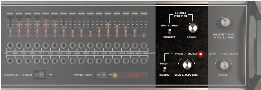
Die menschliche Stimme besteht aus drei Komponenten: Vokale, Konsonanten und Frikative. Frikative sind eine bestimmte Art von Konsonanten, die durch Rauschen erzeugt werden, die den Vokaltrakt verengen (wie S, Z, V, F und H). Vocoder können gut Vokale und die meisten Konsonanten reproduzieren, aber hochfrequente Frikative sind mit herkömmlicher Filterung schwer zu erzeugen. Die High Freq-Bedienelemente leiten hohe Frequenzen an den Vocoder weiter, um die Verständlichkeit zu verbessern.
