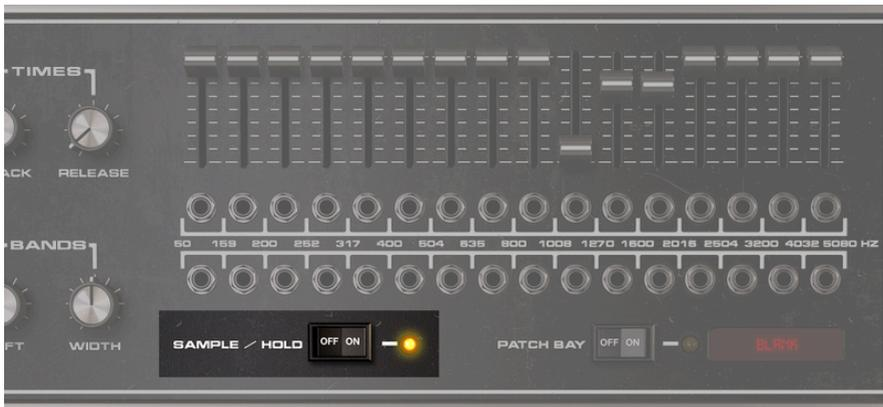
**Sample / Hold:** Wenn aktiviert (On) werden die Pegel der Modulatorsteuerausgänge gehalten, welche die Carrier-Bänder speisen. Alle von Ihnen gespielten Carrier-Tasten werden von den gehaltenen Modulator-Steuerausgängen auf dieselbe Weise beeinflusst. Schalten Sie Sample/Hold aus (Off), um zum normalen Betrieb zurückzukehren.
