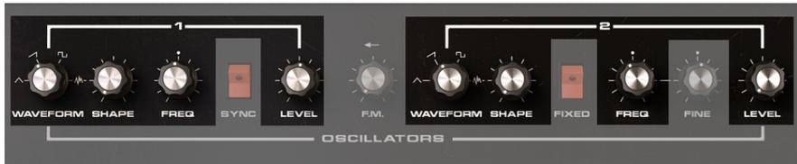
**Waveform** wählt die Wellenformen Dreieck (Triangle), Sägezahn (Saw), Rechteck (Square) oder Weißes Rauschen (Noise) für den VCO aus. Obertonreiche Wellenformen wie die Sägezahn-Welle liefern gute Grundlagen für eine hohe Sprachverständlichkeit. Moduliertes Rauschen klingt fast wie eine lärmende Menschenmenge.
