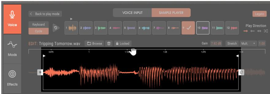
Acercar permite colocar los puntos de inicio y final (o puntos de bucle, consulta la siguiente sección) con mayor precisión. La imagen de arriba muestra la imagen anterior, pero ampliada. Para ampliar o reducir, coloca el cursor sobre la regla de tiempo para que el cursor se convierta en una mano.
