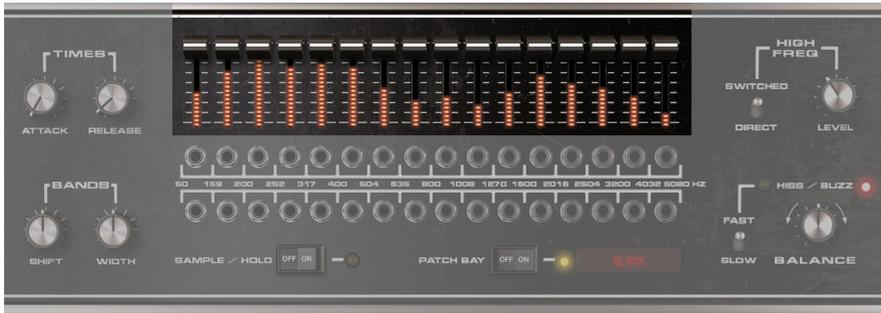
Los 16 deslizadores controlan los niveles de salida de las bandas del sintetizador portador. Utiliza esta función para reducir los niveles de bandas cuyas frecuencias entran en conflicto con otros instrumentos o aumentar los niveles con bandas que ayudan a aumentar la inteligibilidad.
