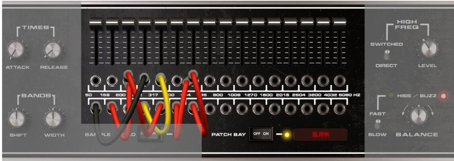
La Bahía de Conexiones permite efectos de vocoder creativos e innovadores. En un codificador de voz estándar, una banda de modulador controla la misma banda de frecuencia para la señal portadora. Con la bahía de conexiones, las señales de análisis de cualquier banda del modulador (fila superior de conexiones) pueden proporcionar señales para articular las bandas del sintetizador portador (fila inferior de conexiones).
