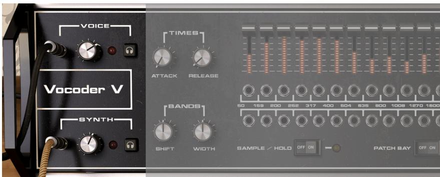
Para optimizar los niveles que ingresan al Vocoder, tanto el Modulador (Voz) como el Sintetizador (Portador) tienen controles de nivel con un rango de ganancia de -75 dB a 0 dB. No establezcas los niveles demasiado bajos, pero evita encender el indicador de recorte rojo a la derecha de cualquiera de los controles de nivel.
