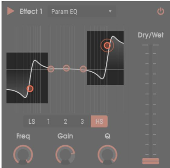
Al cortar la etapa Estante bajo o realzar la etapa Estante alto, Q agrega un corte antes de la frecuencia de corte y un realce después. Al aumentar la etapa Estante bajo o cortar la etapa Estante alto, Q añade un impulso antes de la frecuencia de corte y un corte después. En la imagen de arriba, Q está activado para los filtros Estante bajo (izquierda) y Estante alto (derecha), que están cortando y aumentando respectivamente.
