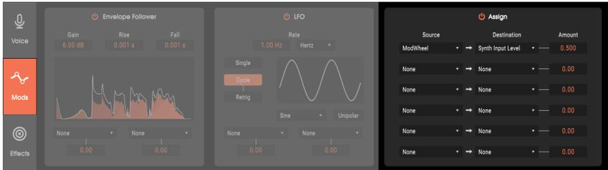
A diferencia de las modulaciones dedicadas como el Seguidor de Envolvente y el LFO, esta sección de modulación de propósito general tiene seis ranuras en las que puedes insertar un modulador y luego aplicar ese modulador a un destino. Todas las fuentes de modulador controlan polifónicamente las voces de la señal portadora, excepto la rueda de modulación, que afecta a todas las voces de la señal portadora a la vez.
