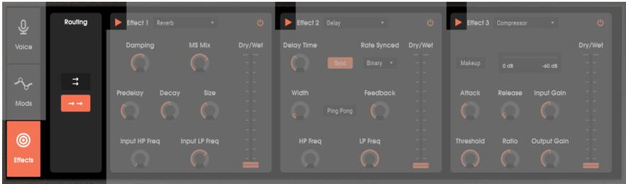
Los botones de Enrutamiento eligen si los efectos están en paralelo (botón de enrutamiento superior) o en serie (botón de enrutamiento inferior). Las flechas en la parte superior izquierda de cada ranura apuntan hacia la derecha para una conexión en serie o hacia abajo para una conexión en paralelo.
