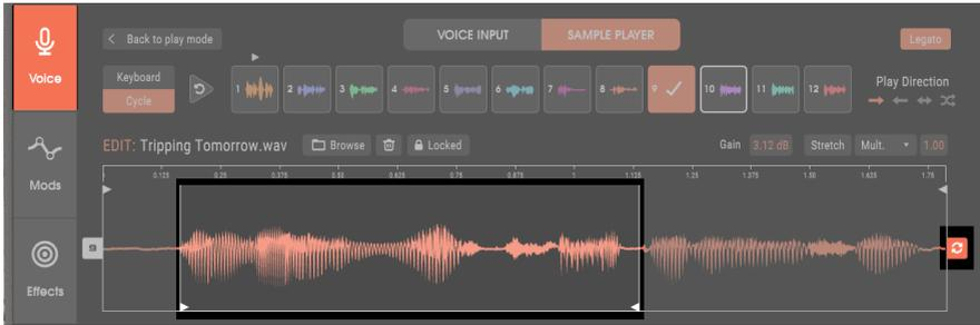
Puedes hacer un bucle hacia adelante de una muestra completa, audio dentro de una muestra o audio dentro de los puntos de inicio y fin de la muestra.
