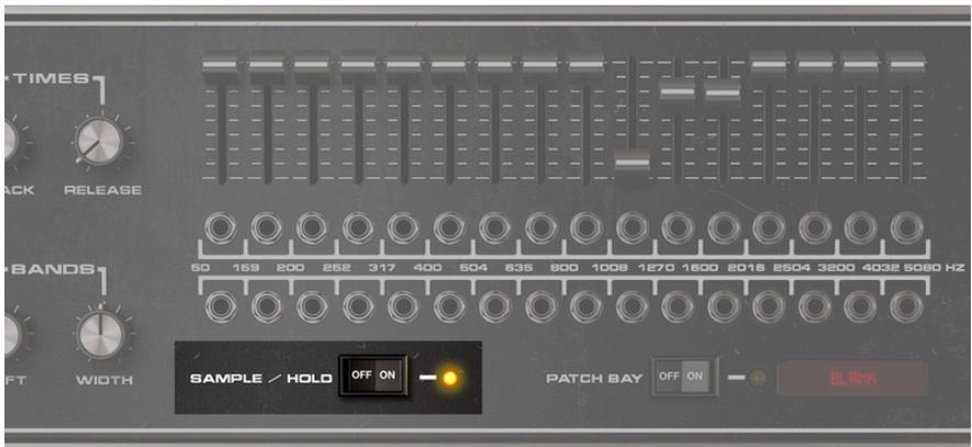
**Muestreo y Retención** Actívalo para mantener los niveles de las salidas de control del modulador que alimentan las bandas del portador. Cualquier tecla del sintetizador portador que toques se verá afectada de la misma manera por las salidas de control del modulador retenidas. Apaga Muestreo y Retención para volver al funcionamiento normal.
