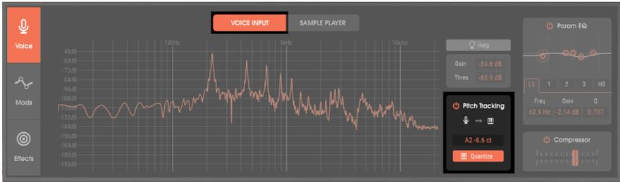
Vocoder V puede detectar el tono de una señal de entrada monofónica y usarlo para disparar el mismo tono en el teclado del sintetizador. Esto permite tocar el teclado cantando, tocando líneas de una sola nota en la guitarra, usando instrumentos de viento, etc., exactamente como si hubieras presionado una tecla. Esto también significa que las funciones Sostener y Acorde funcionan con notas obtenidas del seguimiento de tono; La rueda de inflexión de tono también afectará las notas.
