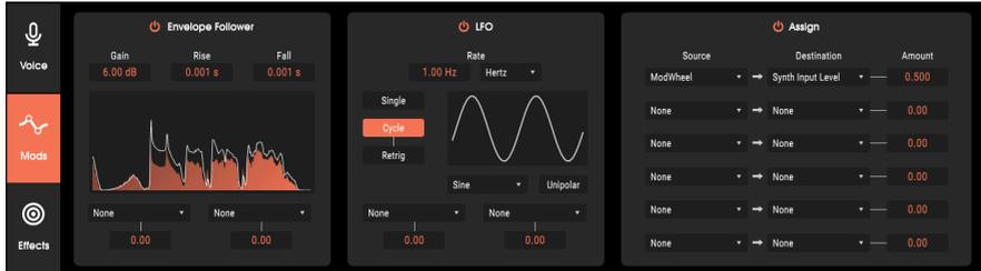
La modulación requiere un mínimo de dos elementos: una fuente de modulación que proporciona señales de control y un destino en el que influirá la modulación. Por ejemplo, vibrato y tremolo son ejemplos comunes de fuentes de modulación. Vibrato agrega cambios de tono periódicos con el tono elegido como destino, mientras que el trémolo proporciona cambios de amplitud periódicos con la amplitud elegida como destino.
