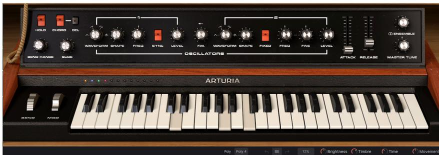
El teclado hace más que tocar notas, porque también puede disparar muestras. La barra de herramientas inferior, debajo de las teclas cuenta con cuatro secciones distintas: selección de polifonía, manejo de deshacer/rehacer, medidor de CPU/botón de pánico y cuatro controles de macro asignables por el usuario.
