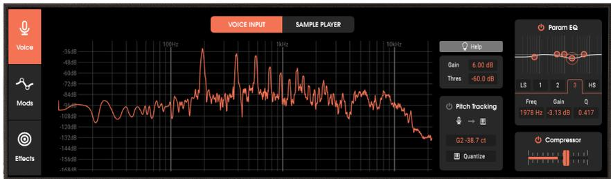
La sección de entrada de voz controla la señal externa procedente de una pista de DAW o la entrada de micrófono de una interfaz de audio en modo independiente. Para simplificar la configuración de la ganancia, la pantalla del Visualizador muestra el nivel de señal y el espectro de frecuencia.
