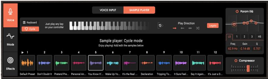
Con este modo, cada nueva nota o acorde dispara la siguiente muestra en la cadena, según la Dirección de ejecución seleccionada, como se selecciona a la derecha del gráfico del teclado.
