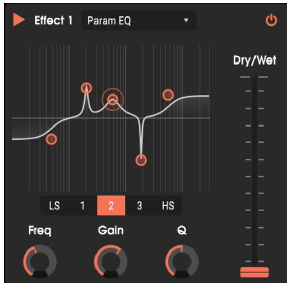
El ecualizador paramétrico es una forma versátil de ajustar la respuesta de frecuencia, porque puede realzar (hacer más prominente) o cortar (hacer menos prominente) rangos específicos del espectro de frecuencias. Este tipo de ecualizador es adecuado para dar forma a un tono amplio o para arreglos quirúrgicos precisos. El EQ paramétrico tiene cinco etapas: estante bajo, tres etapas completamente paramétricas y un estante alto. Cada uno tiene los mismos tres controles asociados.
