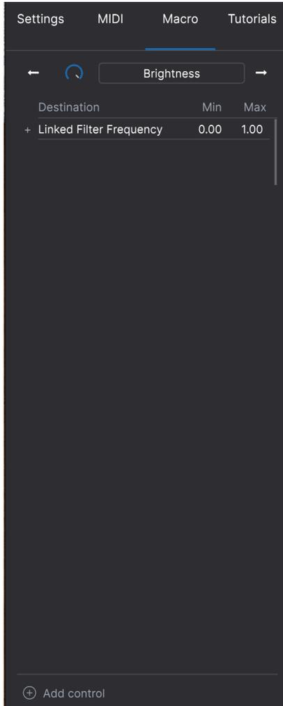
Puedes agregar controles adicionales al macro seleccionando "agregar control" y haciendo clic en el control deseado en el panel. Verás que se agrega a la lista de controles del macro y puedes establecer límites superior e inferior para cada control. Cuando modifiques uno de los controles de macro en la barra de herramientas inferior, verá moverse todos los controles de enlace. ¡Muy útil por cierto!
