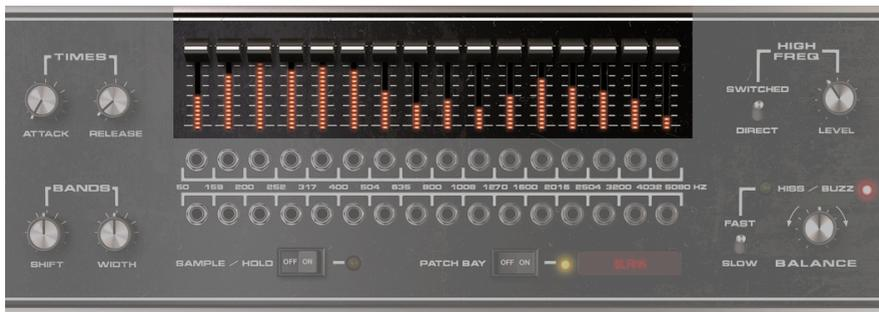
Les 16 atténuateurs contrôlent le niveau de sortie des bandes du synthétiseur porteur. Servez-vous de cette fonctionnalité pour réduire le niveau des bandes dont les fréquences entrent en conflit avec d'autres instruments, ou pour augmenter celui des bandes qui contribuent à l'intelligibilité.
