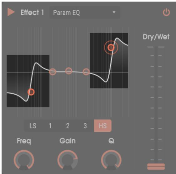
Quand on atténue l'étage du plateau bas ou qu'on augmente l'étage du plateau haut, Q ajoute une atténuation avant la fréquence de coupure et une augmentation après. Quand on augmente l'étage du plateau bas ou qu'on atténue l'étage du plateau haut, Q ajoute une augmentation avant la fréquence de coupure et une atténuation après. Dans l'image ci-dessus, Q a une valeur élevée aussi bien pour le plateau bas (à gauche) que pour le plateau haut (à droite), qui atténuent et augmentent respectivement.
