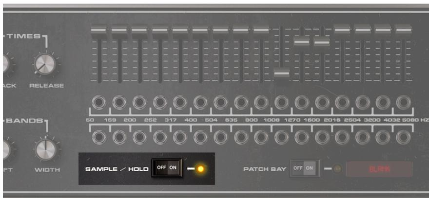
En position On, l'interrupteur **Sample / Hold** bloque le niveau des sorties de contrôle du modulateur qui alimente les bandes du porteur. Toutes les touches que vous enfoncez sur le porteur sont affectées de la même façon par ce paramètre. Basculez sur la position Off pour revenir à un mode d'opération normal.
