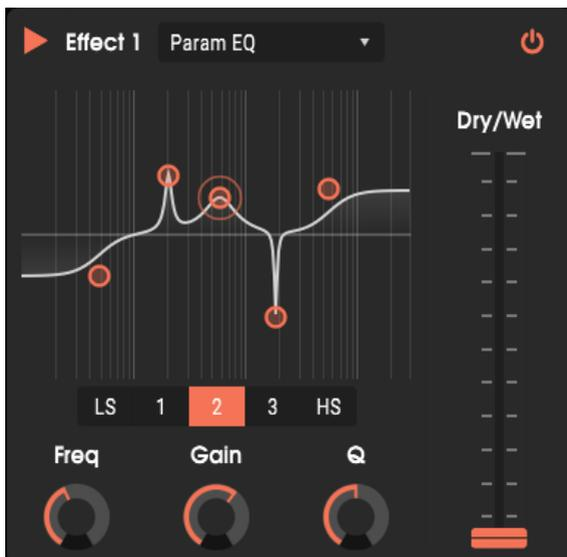
L'égaliseur paramétrique est un outil souple pour ajuster la réponse en fréquence, car il applique un gain ou une atténuation à des plages spécifiques du spectre de fréquences. Ce type d'égaliseur est adapté pour un modelage sonore global aussi bien que pour des interventions de précision chirurgicale. Cet égaliseur graphique a cinq étages : un Low Shelf (plateau bas), trois étages intégralement paramétriques, et un High Shelf (plateau haut). Chacun dispose de trois contrôles identiques.
