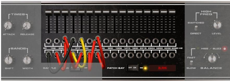
Le panneau de brassage permet d'obtenir des effets de vocodage innovants et créatifs. Sur un vocodeur standard, une bande du modulateur contrôle la bande de même fréquence pour le porteur. Grâce au panneau de brassage, les signaux d'analyse de n'importe quelle bande du modulateur (rangée du haut) peuvent servir à structurer les bandes du synthétiseur porteur (rangée du bas).
